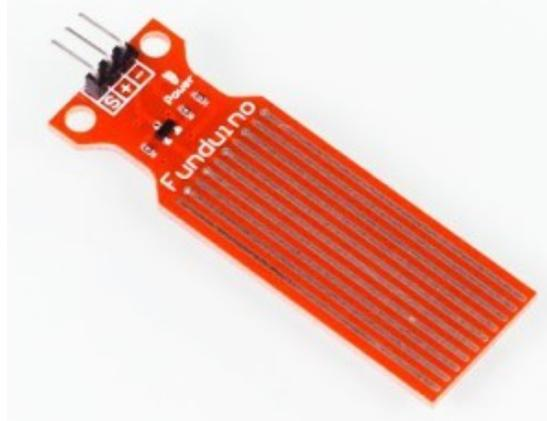
Man kann den Sensor zum Beispiel als Regensensor verwenden. Sobald ein Tropfen auf den Sensor trifft, kann das Arduino-Board eine Aktion ausführen wie z.B. eine Markise einrollen, Jalousien schließen, einen Alarm auslösen oder einen Scheibenwischer betätigen.
