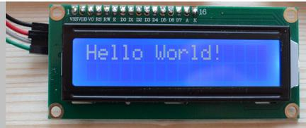
Wird der Arduino in einem Projekt ohne Computer betrieben, muss ein LC-Display eingesetzt werden, um Text oder Variablenwerte darzustellen.
