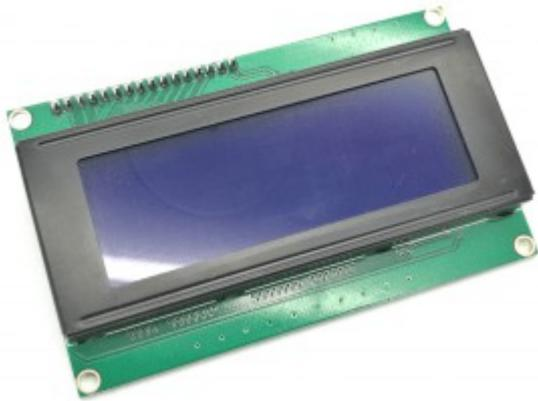
Das vierzeilige LCD Modul mit angelötetem I<sup>2</sup>C Bus ermöglicht die Verwendung eines LCD Moduls mit einer einfachen Verkabelung. Dies ist bei komplexeren Projekten besonders vorteilhaft. Dieses I<sup>2</sup>C LCD Modul hat jeweils 20 Zeichen in 4 Zeilen zur Verfügung. Materialbeschaffung: [www.funduinoshop.com](http://www.funduinoshop.com)
