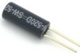
Mit dem Arduino lassen sich auf verschiedenen Art und Weisen Neigungen messen. Sehr exakte Messungen bekommt man zum Beispiel mit einem Beschleunigungssensor, bei dem man nahezu jeden Winkel genau messen kann. Es geht jedoch auch ganz einfach mit dem [Neigungssensor](#) (engl. Tilt sensor oder Tiltswitch). Materialbeschaffung: [www.funduinoshop.com](http://www.funduinoshop.com)
