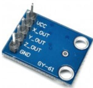
Aufgabe: Der Beschleunigungssensor ADXL335 soll mit Hilfe eines Arduino-Mikrocontrollers ausgelesen werden. Der Sensor wird hierbei verwendet um die Lage der X- und Y-Achse des Sensors zu ermitteln.
