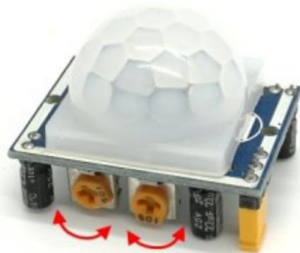
Die Kunststofflinse ist nur leicht gesteckt. Wenn man sie abhebt kann man den Infrarotdetektor erkennen und man sieht anhand der Beschriftung unter der Linse, wie der Sensor verkabelt werden muss: GND (–), OUT (Ausgang des Signals), VCC (+).
