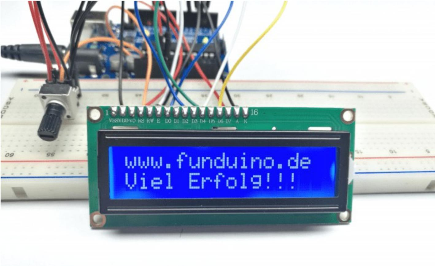
Material: Arduino Mikrocontrollerboard (In diesem Beispiel UNO R3), ein Drehregler (bzw. Potentiometer), 14 Jumperkabel, Breadboard ([Materialbeschaffung: www.funduinoshop.com](http://www.funduinoshop.com))
