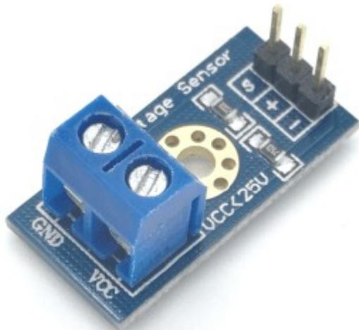
Aufgabe: Eine Spannung mit einem Spannungssensor (Voltage sensor) messen und auf dem seriellen Monitor anzeigen lassen.
