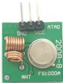
Um den Sender zu verkabeln, wird der Data-Pin mit Pin 10 des Arduinos, VCC mit 5V und GND mit GND verbunden.
