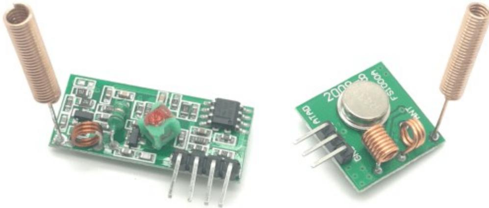
Auf der 433mhz Frequenz werden die gesendeten Daten unverschlüsselt übermittelt. Man sollte sich also darüber im Klaren sein, dass andere Personen die Daten abfangen könnten. Der Sender kann von ca. 3,5V bis 12V betrieben werden. Je höher die Spannung, desto höher ist die Reichweite. Mit einer zusätzlichen Antenne lässt sich die Reichweite ebenfalls erhöhen.
