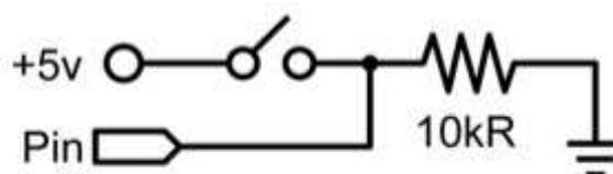
Dies ist die einfachste Form eines Einganges mit nur zwei möglichen Zuständen: ein oder aus. Dieses Beispiel liest einen einfachen Schalter oder Taster an Pin 2 aus. Wenn der Schalter geschlossen ist und der Eingangspin HIGH ist wird die LED eingeschaltet.
