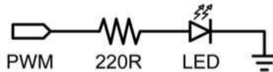
Pulsweiten Modulation (PWM) ist eine Methode um analoge Ausgänge zu simulieren, indem man die Ausgangsspannung pulsiert. Damit kann man zum Beispiel eine LED heller oder dunkler werden lassen oder später einen Servomotor kontrollieren. Das folgende Beispiel lässt eine LED mit Hilfe einer Schleife langsam heller und dunkler werden.
