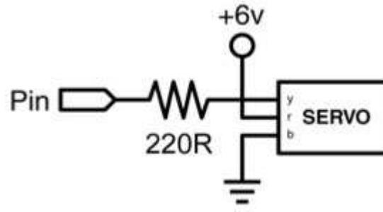
Hobby-Servos sind eine geschlossene Motoreinheit, die sich in der Regel in einem 180-Grad-Winkel bewegen lassen. Es braucht nur einen Puls der alle 20ms gesendet wird. In diesem Beispiel wird eine servoPulse-Funktion genutzt um das Servo von 10-170 Grad und wieder zurück zu bewegen.
