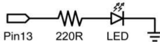
Dies ist ein einfaches 'Hallo Welt'-Programm und schaltet etwas ein und aus. In diesem Beispiel ist eine LED an PIN 13 angeschlossen und blinkt jede Sekunde. Der Widerstand mag an diesem Pin überflüssig sein, weil der Arduino einen eingebauten Widerstand besitzt.
