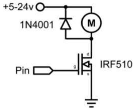
Machmal ist es notwendig mehr als die 40 Milliampere der Ausgänge des Arduino zu kontrollieren. In diesem Fall kann ein MOSFET oder Transistor benutzt werden um höhere Stromstärken zu schalten. Das folgende Beispiel schaltet einen MOSFET etwa 5 mal pro Sekunde ein und aus.
