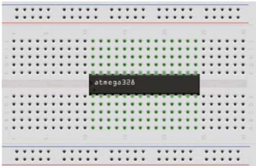
Abbildung 25-6: Platzieren Sie den ATmega-Chip in der Mitte des Steckbretts.
