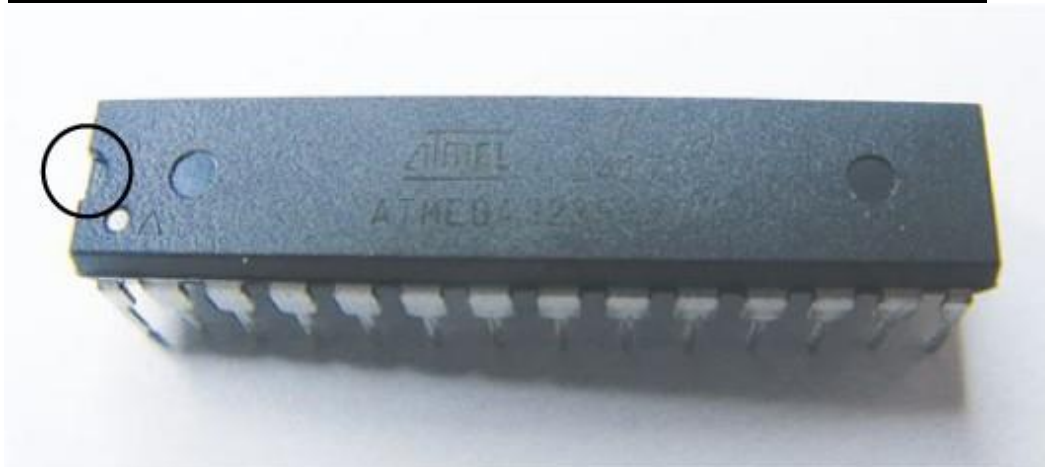
Abbildung 25-3: Die Oberseite des Chips hat eine kleine halbkreisförmige Markierung.
