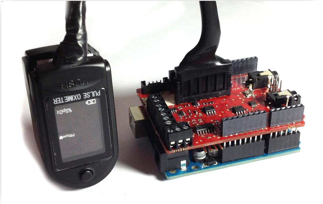
Abbildung 59: Arduino-Uno, Sensor-Shield und Puls-Oxygen-Sensor
