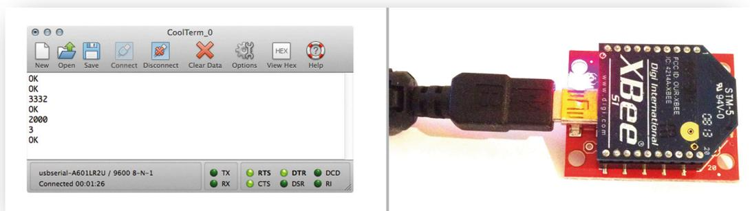
Abbildung 54: CoolTerm Ausgabe bei XBee-Konfiguration
