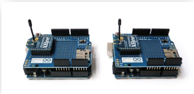
Abbildung 24: Arduino Wireless-SD-Shield [59]
