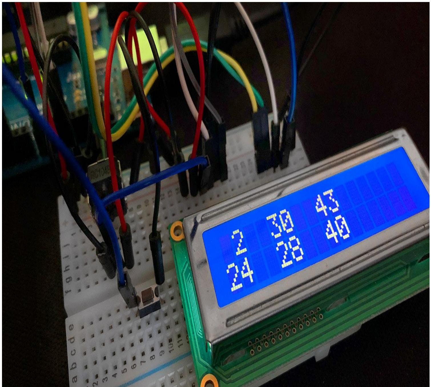
Wir bauen einen Lottozahlen-Generator mit Arduino. Dazu verwenden wir ein LCD-Display für die Ausgabe. Gestartet wird der Generator mit einem Button.
