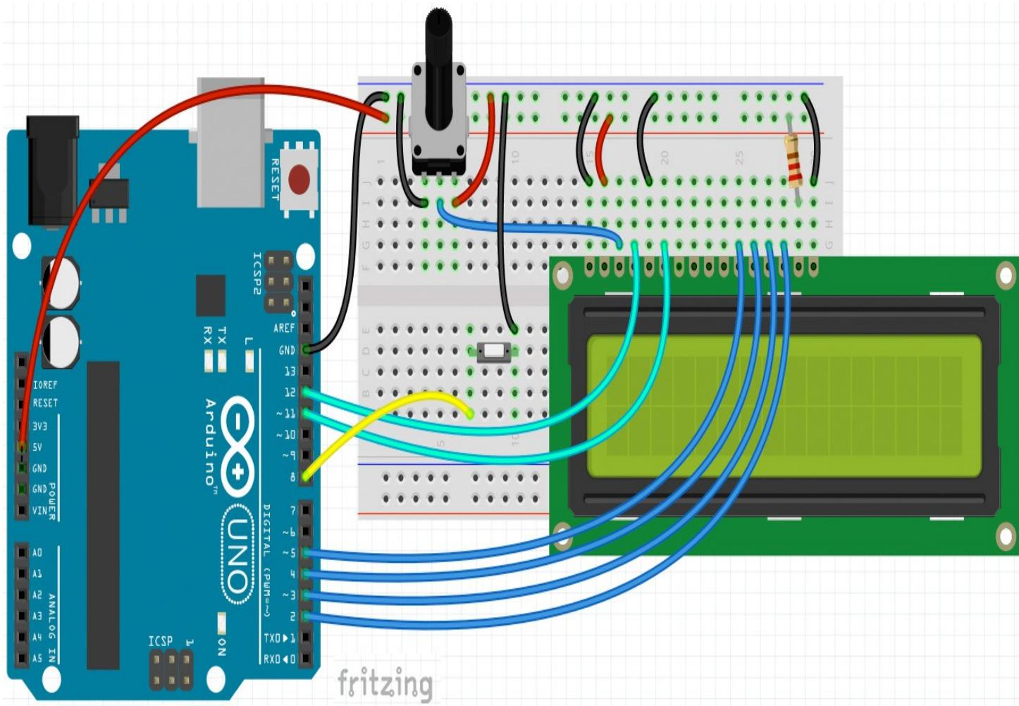
Das LCD wird ganz normal an das Arduino-Board angeschlossen. Wie das genau geht, habe ich schon mal hier erklärt: [LCD-Display mit Arduino steuern](#). Zusätzlich ist noch ein Button in die Schaltung eingefügt. Wird der Button gedrückt, werden die neuen Lottozahlen generiert.
