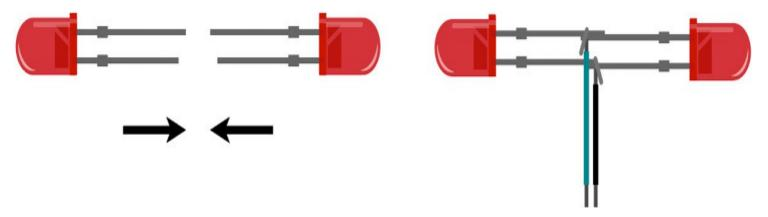
Biege die beiden LEDs, sodass sie in die gleiche Richtung leuchten. Das wären also schon mal zwei Augen. Wiederhole das, solange du Lust hast. Ich hab neun Augenpaare gelötet.
