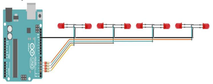
Knüpfe aus dem Kabel einen Kabelbaum, bei dem die GND-Ader die gesamte Länge ausmacht. Die Augenpaare sollten ca. 15 cm auseinander sein. Pro Augenpaar brauchst du nun ein Versorgungskabel mit Vorwiderstand (220 Ohm). Diese kannst du entweder direkt anlöten, oder ein kleines Breadboard zwischenschalten.
