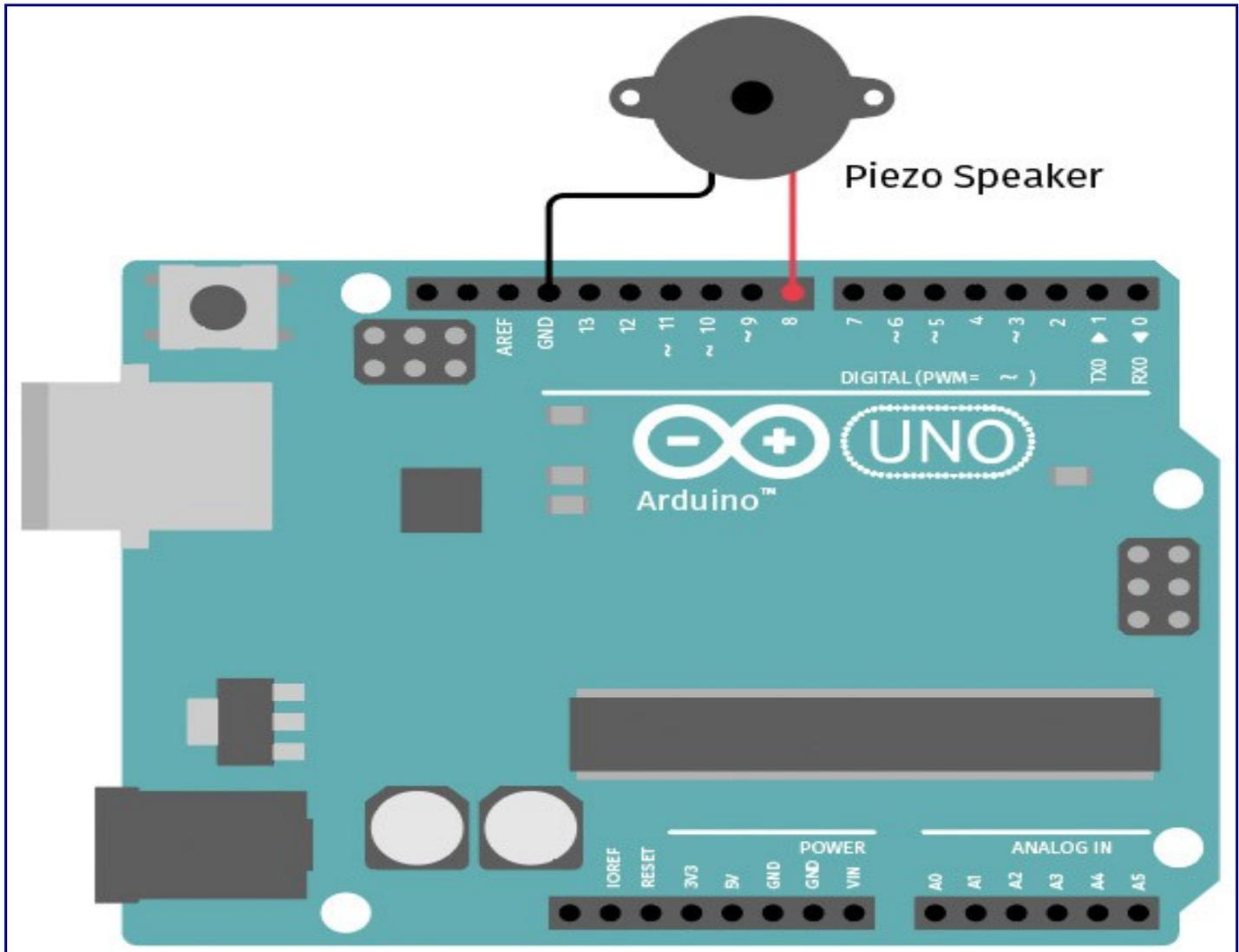
Die Schaltung besteht aus einem Arduino UNO und einem Piezo-Speaker. Dieser wird einfach an den digitalen Pin 8 und den GND des Arduinos verbunden.
