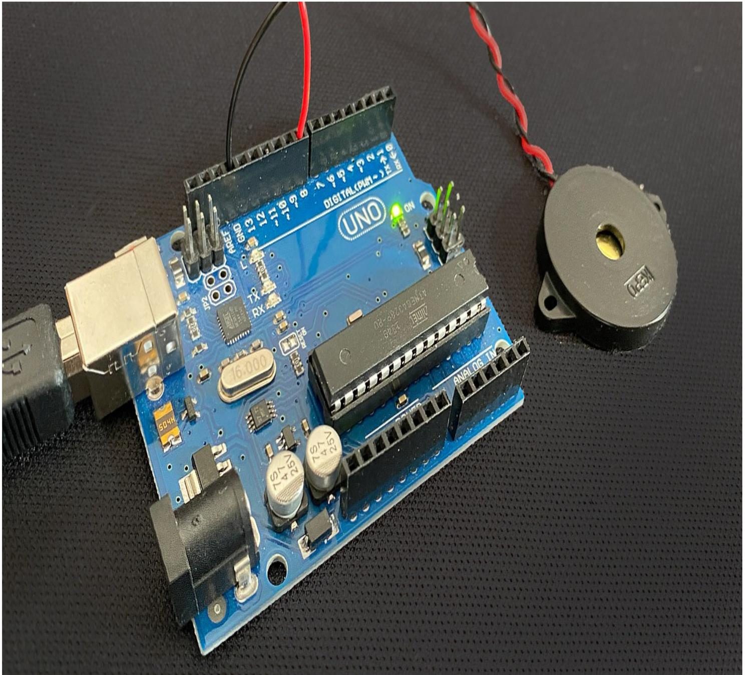
Wenn man in die Welt der Mikrocontroller-Programmierung eintaucht ist eines der ersten Übungen das Blinken eines SOS in Morse-Code. Aber wie geht es dann weiter? Morsen mit Arduino: In diesem Projekt erfährst du, wie du über den Seriellen Monitor Text eingeben und per Arduino in Blinken und Piepsen umwandeln kannst.
