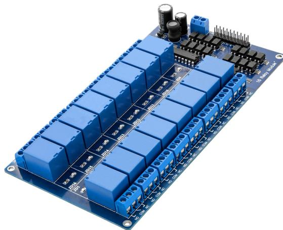
Mit den 16 Relais können größere Lasten (bis 5A) an einem Mikrocontroller oder µC mit 5V Ausgang betrieben werden.
