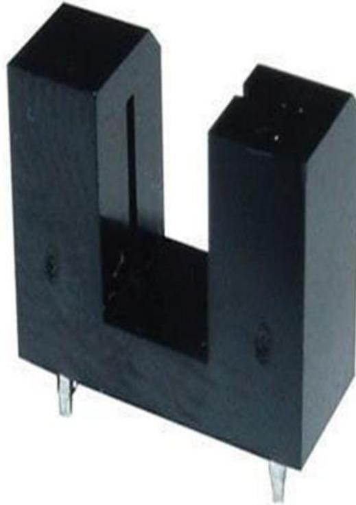
Wenn kein Hindernis zwischen Sender und Empfänger (=im Bereich zwischen den Zinken der Gabel) ist, schaltet der Lichtstrahl den Fototransistor durch, so dass 0V am Ausgang des Moduls anliegt. Dies ist sehr schön im nachfolgenden Bild zu sehen. Der Phototransistor schaltet in diesem Fall Knoten 3 auf die selbe Spannung wie Knoten 4.
