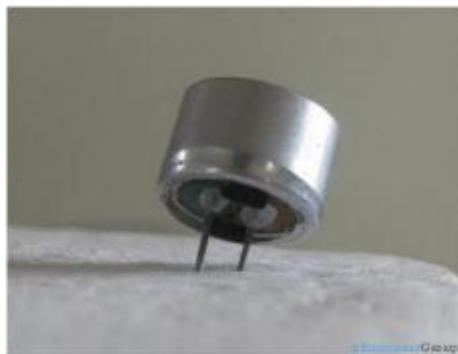
Diese Mikrofone werden häufig in elektronischen Schaltungen eingesetzt, um kleine Geräusche oder Luftschwingungen zu erkennen, die wiederum in elektrische Signale für die weitere Verwendung umgewandelt werden. Die beiden Beinchen, wie im Bild oben gezeigt, dienen zur elektrischen Verbindung mit der Schaltung.
