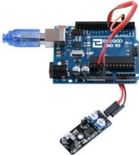
Der Code funktioniert so, dass wenn ein Hindernis erkannt wird vom Modul, ist die eingebaute LED auf dem Arduino ausgeschaltet. Wird kein Hindernis erkannt (wenn also freie Bahn ist), leuchtet die LED 13.
