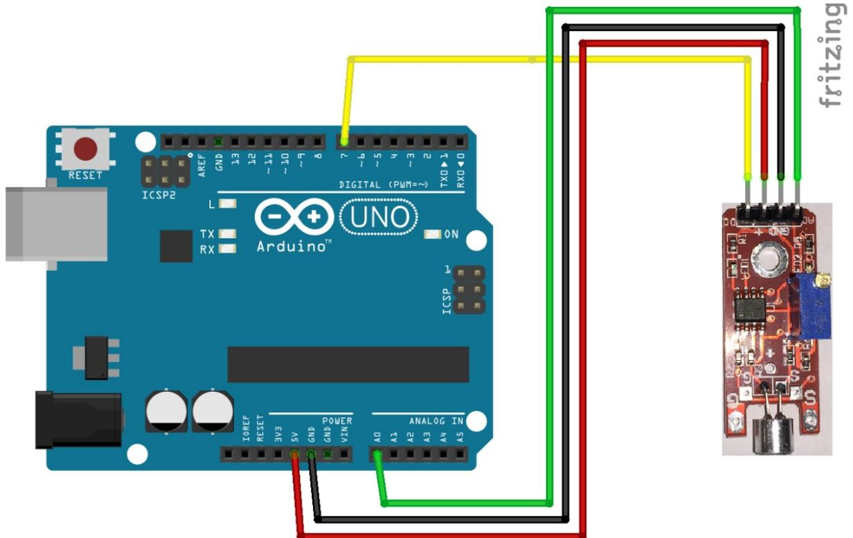
+ wird mit **5V** am Arduino verbunden
