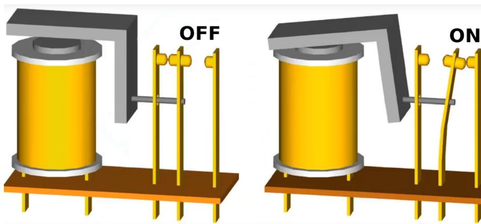
Im nicht aktiven Zustand befindet sich der Schalter im AUS-Zustand, der "NC"-Pin ist mit dem gemeinsamen (common) Pin verbunden und "NO" ist nicht verbunden. Wenn der Strom an den Elektromagneten angeschlossen wird (über Transistor und Gleichrichterdiode), wird der Schalter in den aktiven Zustand versetzt, wodurch der common Pin mit dem "NO"-Pin verbunden wird.
