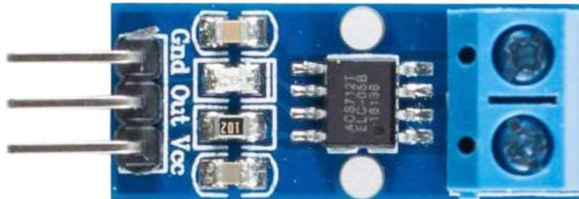
Der Sensor verwendet den Hall-Effekt, um zu bestimmen wieviel Strom hindurchfließt. Der Strom, der durch das Modul fließt, generiert ein Magnetfeld, welches vom Sensor erfasst und in einen analogen proportionalen Wert umgewandelt wird.
