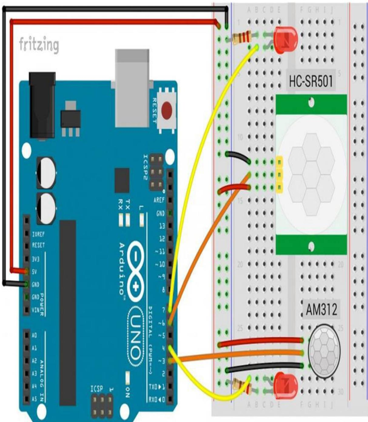
Die Schaltung ist für beide Sensoren sehr einfach. Sie werden nur mit GND, 5V+ und einem digitalen Input verbunden.
