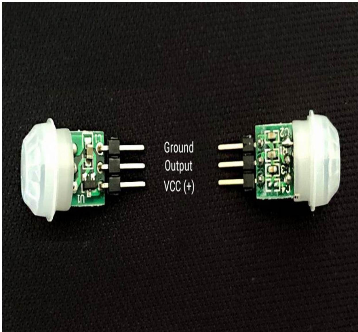
Wesentlich kleiner als der HC-SR501 bietet der AM312 weniger Einstellmöglichkeiten. Er lässt sich dafür in kleinere Aufbauten integrieren, funktioniert in einem Spannungsbereich zwischen 2.7 – 12V und verbraucht weniger als 1mA, was ihn besonders in Batterie gestützter Verwendung interessant macht.
