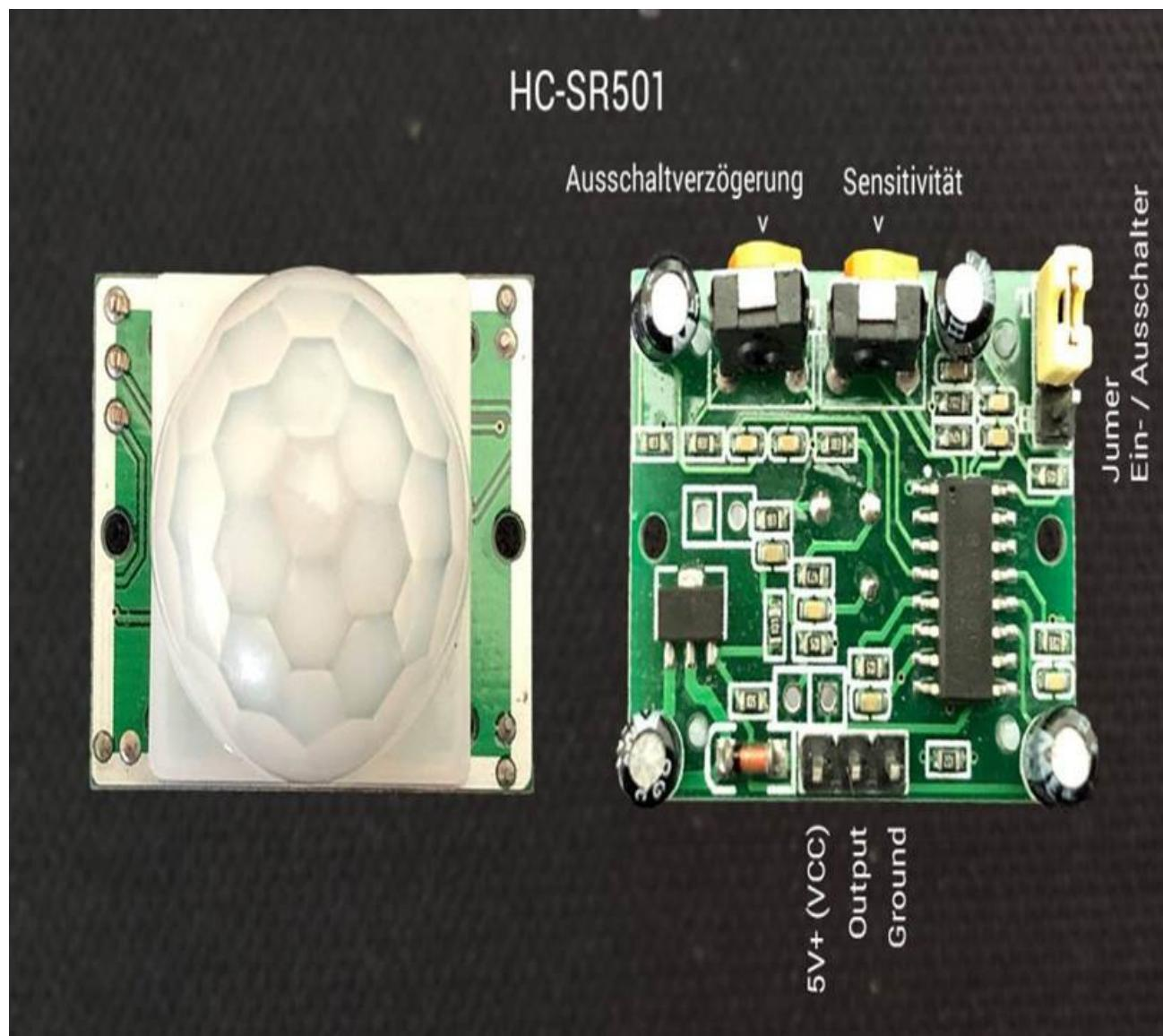
Der HC-SR501 ist ein PIR Bewegungssensor, der über zwei Potentiometer zur Einstellung von Empfindlichkeit und Schaltdauer verfügt. Des Weiteren kann man ihn per Jumper als Einschalter oder Ausschalter konfigurieren. Er ist für eine Betriebsspannung von 5V ausgelegt und verbraucht 65mA.
