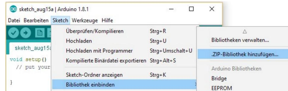
Suche anschließend nach "**DHT22**" und installiere die "**DHT sensor library by Adafruit**".
