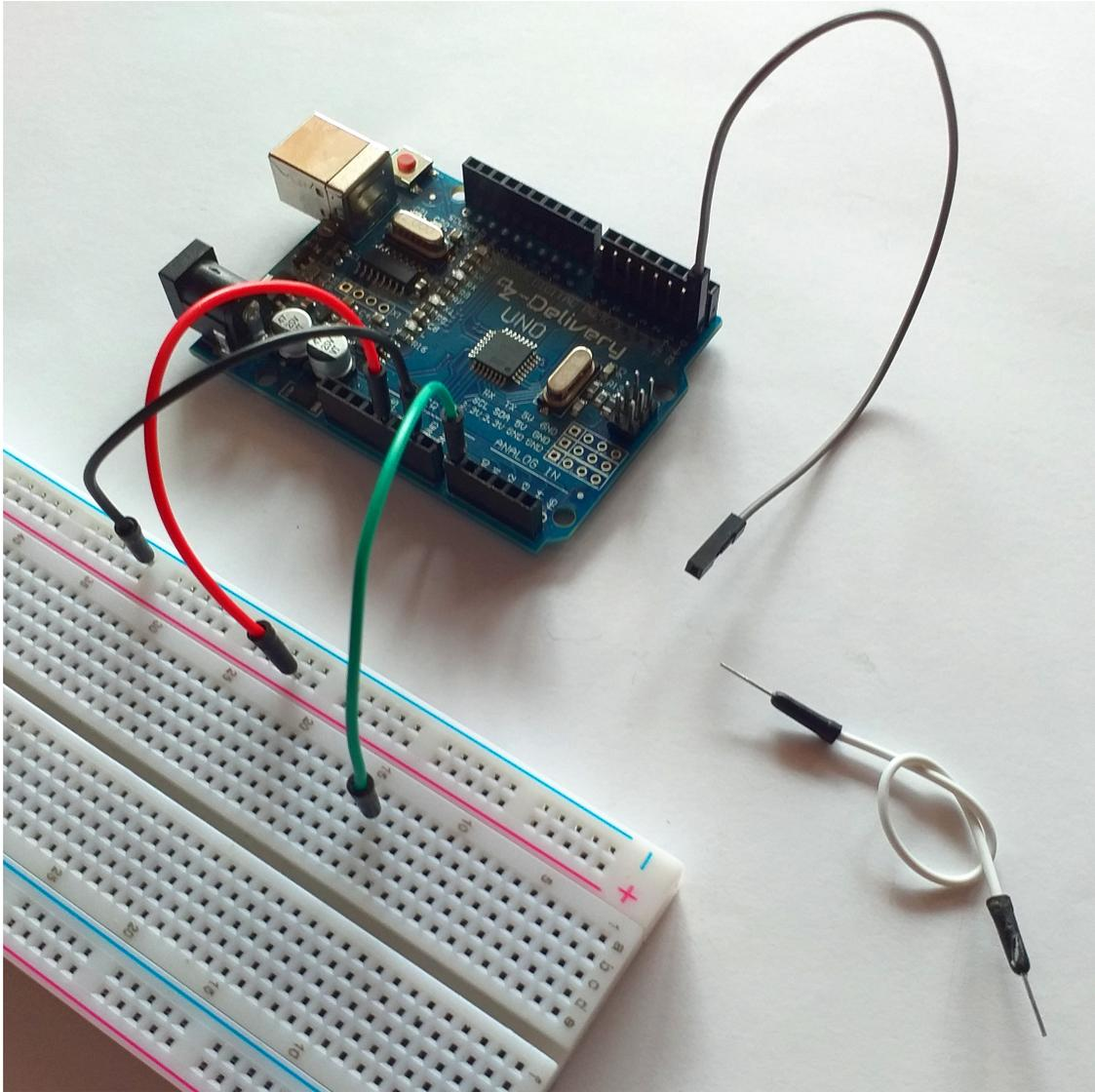
Wir verwenden Breadboard- und Jumperkabel, um Verbindungen mit unseren Arduino Uno herzustellen, die Buchsen- und Stiflleisten haben.
