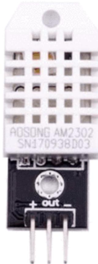
**"+"-Pin** - liefert die Stromversorgung für den Sensor. Obwohl die Versorgungsspannung zwischen 3,3V und 5,5V liegen kann, wird eine 5V-Versorgung empfohlen. Im Falle einer 5V-Versorgung können Sie Kabel mit einer Länge von bis zu 20 Meter verwenden, um den Sensor und den Mikrocontroller zu verbinden. Bei einer Versorgungsspannung von 3,3V darf die Kabellänge jedoch nicht größer als ein Meter sein. Andernfalls führt der Leitungsspannungsabfall zu Messfehlern.
