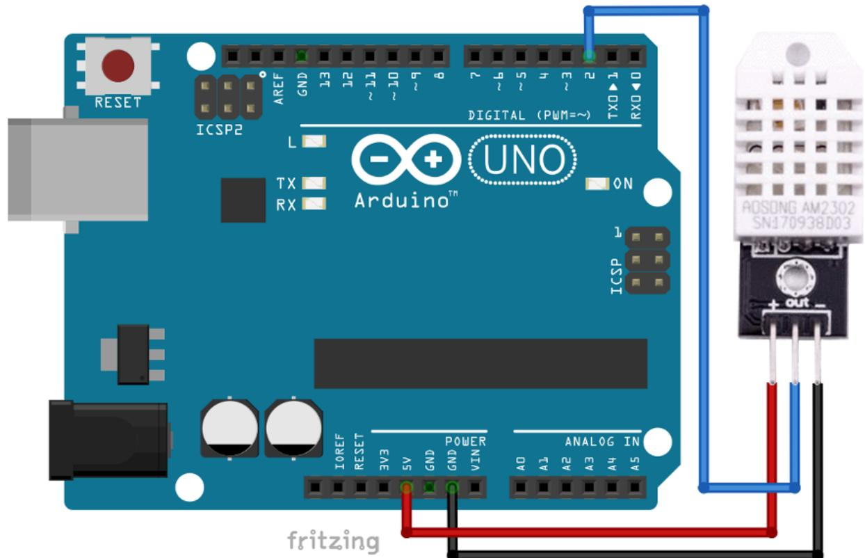
**DHT22 Pin > Arduino Uno Pin**
