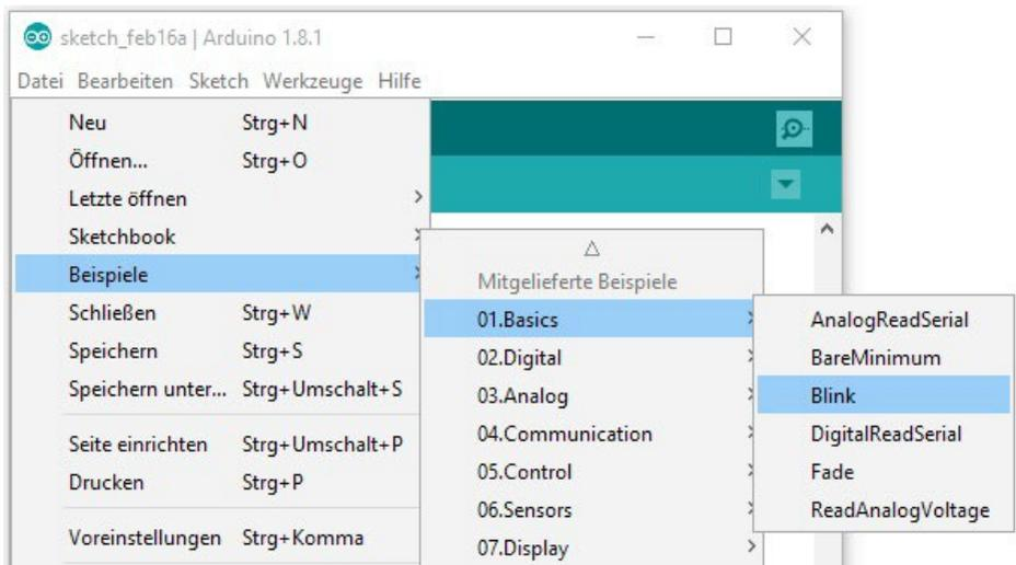
Jeder Sketch enthält immer die Methoden "**setup**" und "**loop**". Erstere wird zu Beginn ausgeführt und in der Regel zur Initialisierung von Pins und angeschlossener Hardware verwendet. Die loop-Methode wird im Anschluss permanent wiederholt und enthält damit fast alle anderen Funktionen.
