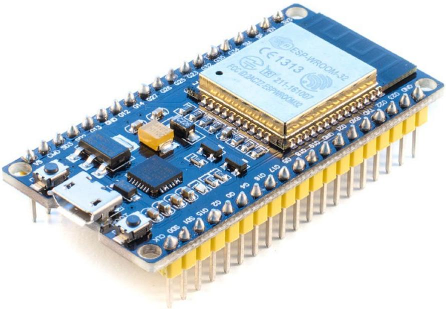
Der **ESP32-Chip** ist ein leistungsstarker Nachfolger des sehr beliebten **ESP8266**, welcher beispielsweise in den **AZ-Delivery NodeMCUs Amica V2** und **Lolin V3** verbaut ist. Die größte Neuerung ist dabei die hinzugekommene Bluetooth 4.2 BLE Konnektivität. Das **AZ-Delivery ESP-32 Development-Board** ist der perfekte Begleiter für den flexiblen Einsatz im Internet of Things.
