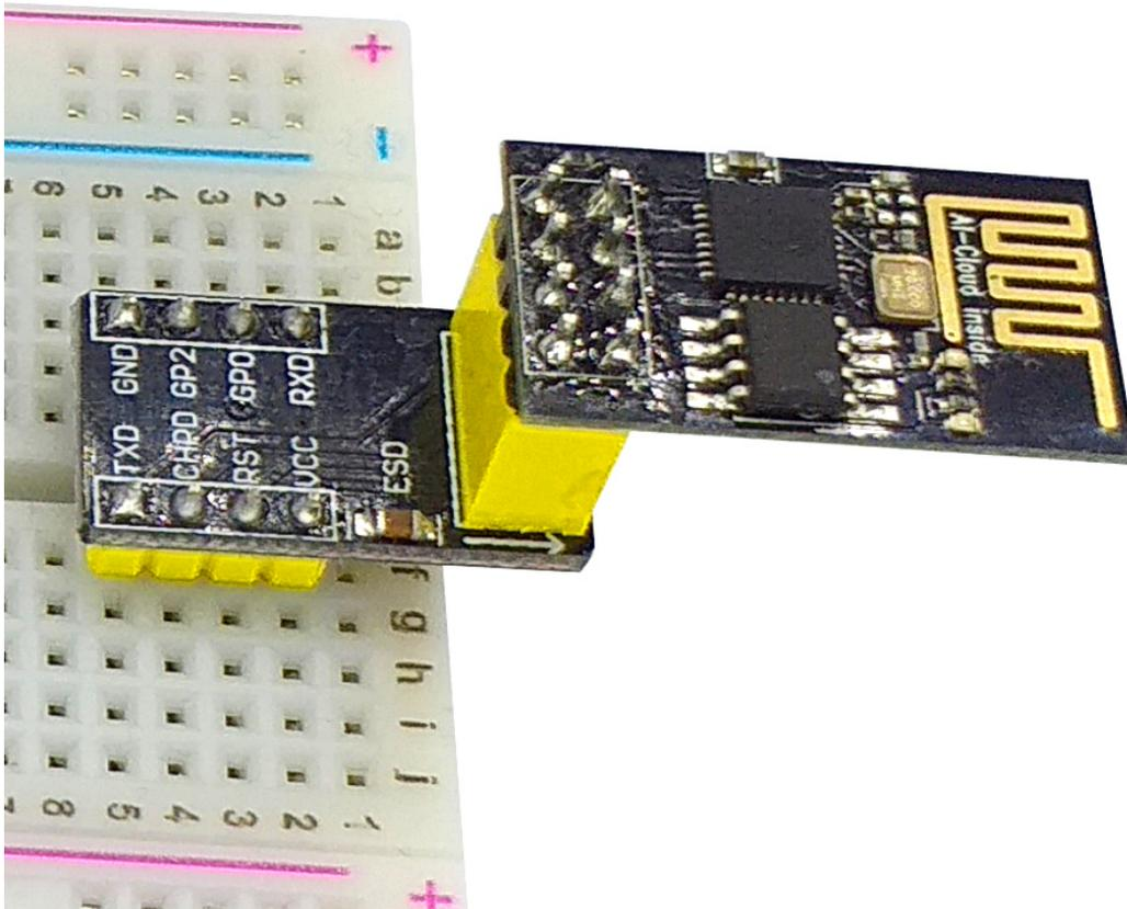
Stellen Sie sicher, dass Sie das Modul ESP8266-01, wie abgebildet anbringen, da die Aufkleber auf dem Breadboardadapter tatsächlich Pins sind, die das Breadboard mit dem Modul ESP8266-01 verbinden. Sollten Sie diese anders verbinden, könnten Sie das Modul ESP8266-01 beschädigen.
