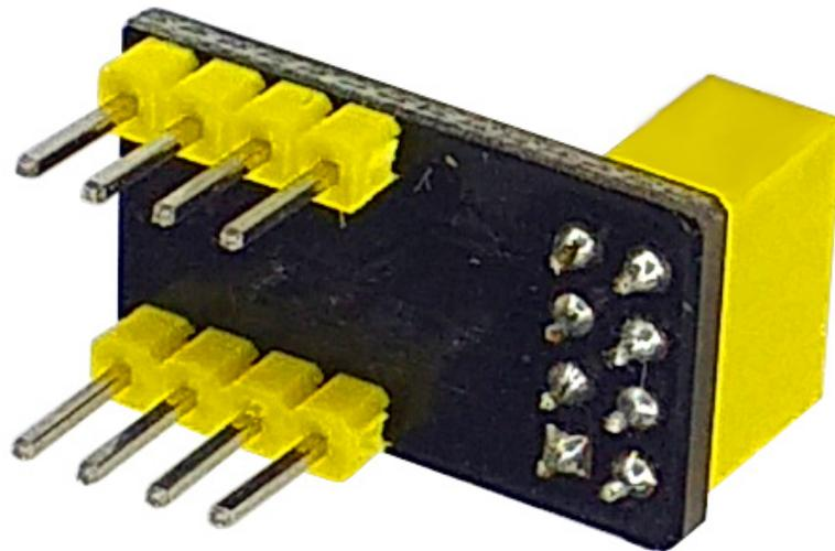
**Hinweis:** Der Adapter kann sowohl für ESP8266-01- als auch für ESP8266-01S-Module verwendet werden.
