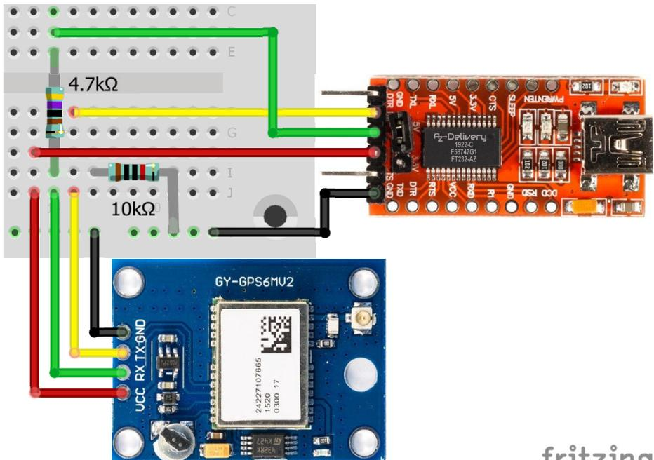
Im Anschluss daran musst du nur noch den Adapter mit deinem Rechner verbinden, die **Arduino IDE** starten, den richtigen Port wählen und das **Terminal** bei einer **Baud-Rate** von **9600** öffnen. Sobald das GPS-Modul mit Spannung versorgt wird, sucht es nach seiner Position und gibt diese über die **serielle Verbindung** weiter.
