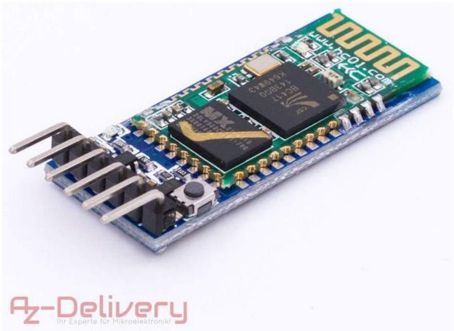
Der **AZ-Delivery HC-05** ist ein Bluetooth 2 EDR-fähiges Gerät und nutzt das 2,4-Ghz-Band. Das Modul bietet außerdem eine Serielle UART-Schnittstelle für die einfache Integration mit Mikrocontrollern.
