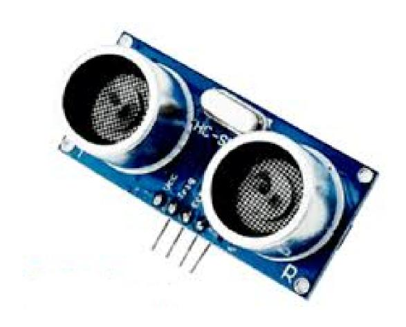
Der Ultraschallsensor "HC-SR04" verwendet Ultraschallwellen, um den Abstände zu Objekten zu bestimmen. Das Modul "HC-SR04" kann berührungslose Messungen in einem Bereich von 20 bis 4000 Millimeter mit einer Genauigkeit von 3 Millimetern durchführen. Jedes "HC-SR04"-Modul verfügt über einen Ultraschall-Sender, -Empfänger und eine elektronische Schaltung.
