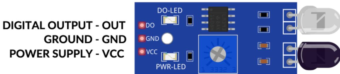
Das Modul arbeitet mit einem Spannungsbereich von 3,3V und 5V .
