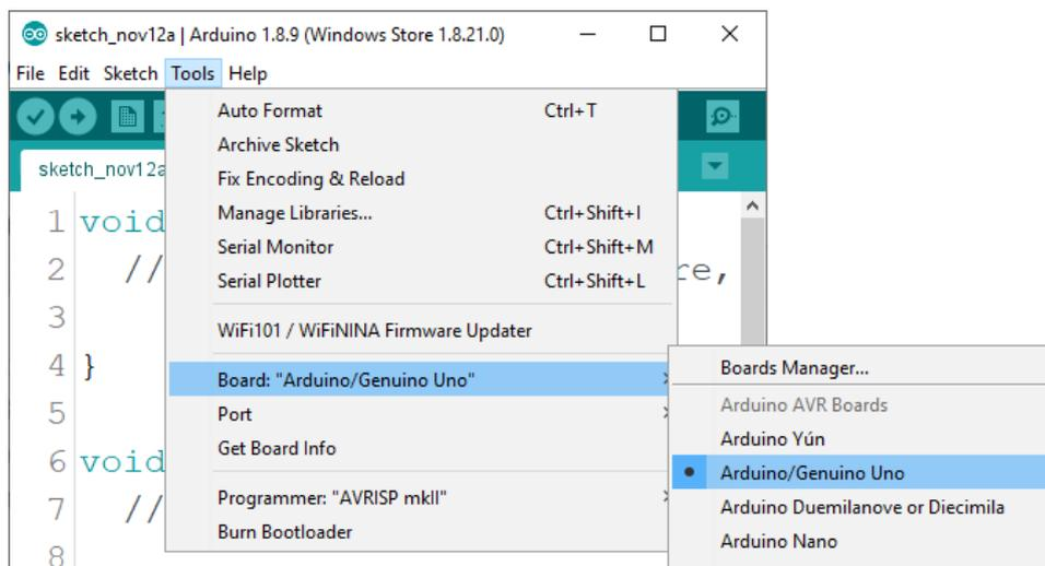
Der Port, an den das Arduino-Board angeschlossen ist, muss ausgewählt werden. Gehe zu: *Tools > Port > {port name goes here}* und wenn das Arduino-Board an den USB-Port angeschlossen ist, ist der Portname im Drop-down Menü auf dem vorherigen Bild zu sehen.
