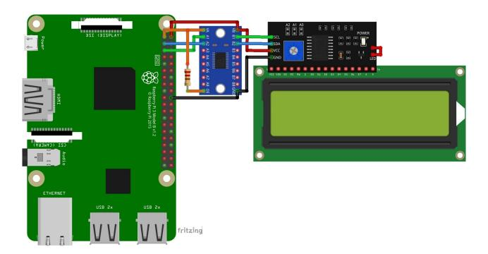
Hier muss der Logikpegelwandler verwendet werden, da der I2C-Adapter nur im 5V-Bereich arbeitet. Der in diesem eBook verwendete Logikpegelwandler heißt *TXS0108E Logic Level Converter*.
