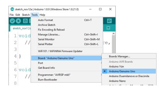
Der Port, an dem das Microcontroller-Board angeschlossen ist, muss ausgewählt werden. Gehe zu: Tools > Port > {port name goes here} und wenn das Microcontroller-Board an den USB-Port angeschlossen ist, ist der Portname im Drop-down Menü auf dem vorherigen Bild zu sehen.
