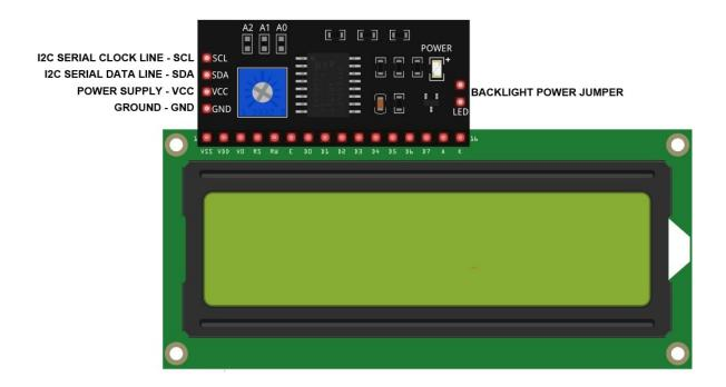
**Hinweis**: Es ist notwendig, den I2C-Adapter und die LCD-Anzeige genau, wie oben abgebildet, anzuschließen. Wenn anders angeschlossen wird, können die Geräte beschädigt werden.
