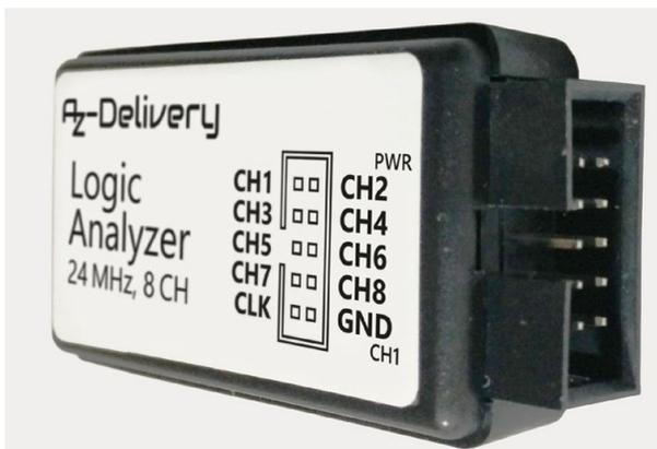
An dieser Stelle musst Du etwas umdenken, da das Programm Saleae Logic bei 0 zu zählen beginnt, d.h. **CH1 = Channel 0** und **CH2 = Channel 1**.
