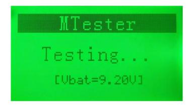
Der Komponententester zeigt eine Eingangsspannung von 9,2 Volt an – und erkennt dann das eingelegte Bauteil.
