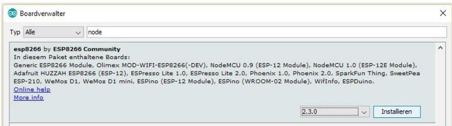
Nun kannst du das richtige Board namens **"NodeMCU 1.0 (ESP12E Module)"** auswählen, dazu die CPU Frequenz von 80 MHz, die Speichergröße **"4M (3M SPIFFS)"**, eine Baud-Rate von z. B. 115200 und den passenden Port ("COM" bei Windows "ttyUSB" bei MacOS).
