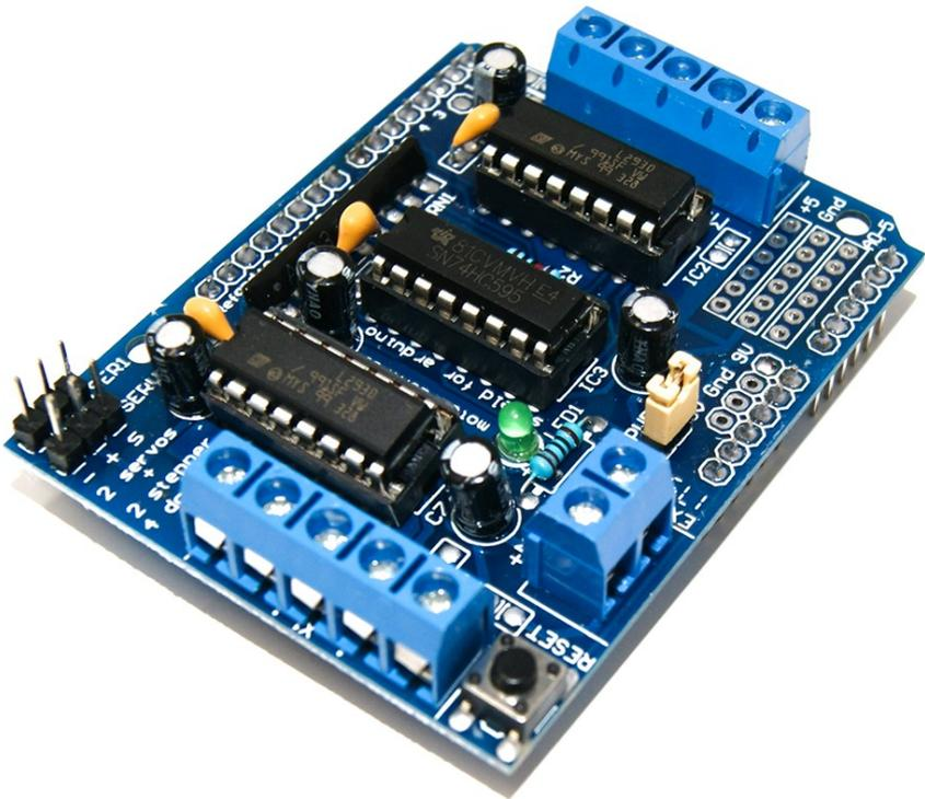
Das 4-Kanal L293D Motortreiber Shield wird einfach auf ein Arduinoboard aufgesteckt und erlaubt es bis zu 4 DC Motoren, 2 Schrittmotoren oder 2 Servomotoren anzusteuern. Als H-Brücke dient der leistungsfähige und zuverlässige L293D Chip der die Last verteilt. Dadurch können Sie problemlos DC-Motoren und Netzteile bis 36V verwenden.
