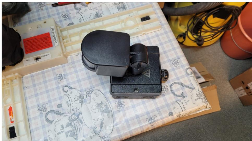
Die Box mit Kabelbinder an der Spinne befestigen und den Empfänger an Footpad anschließen.
