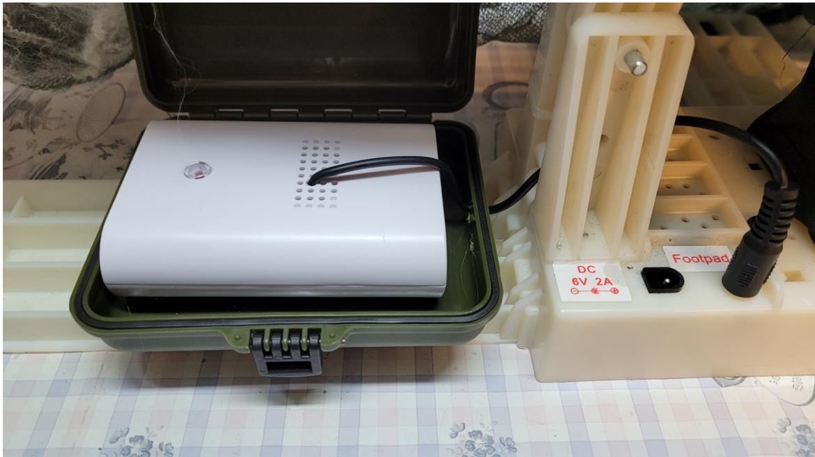
Wenn alles richtig angeschlossen ist, den Schalter der Spinne von Off auf Footpad stellen. Vor dem Einbau prüfen ob der Sender mit dem Empfänger kommuniziert (beide auf dieselbe Frequenz eingestellt sind). Wichtig!!! Erst die Batterie in den Sender einlegen, danach in den Empfänger die Batterien einlegen. Innerhalb von 120 sec muss der Sender einmal ausgelöst werden um ein Signal an den Empfänger zu senden.
