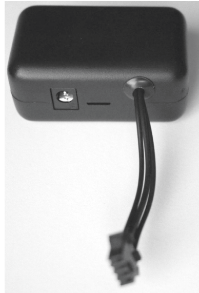
Abbildung 7.21: Level-Konverter 3.3 V auf 5 V (Quelle: lightberry.eu ).
