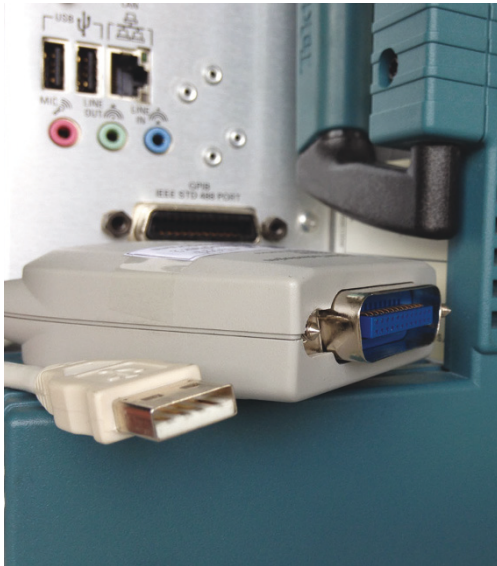
(a) GPIB -Messgerät mit Buchse und Interface.
