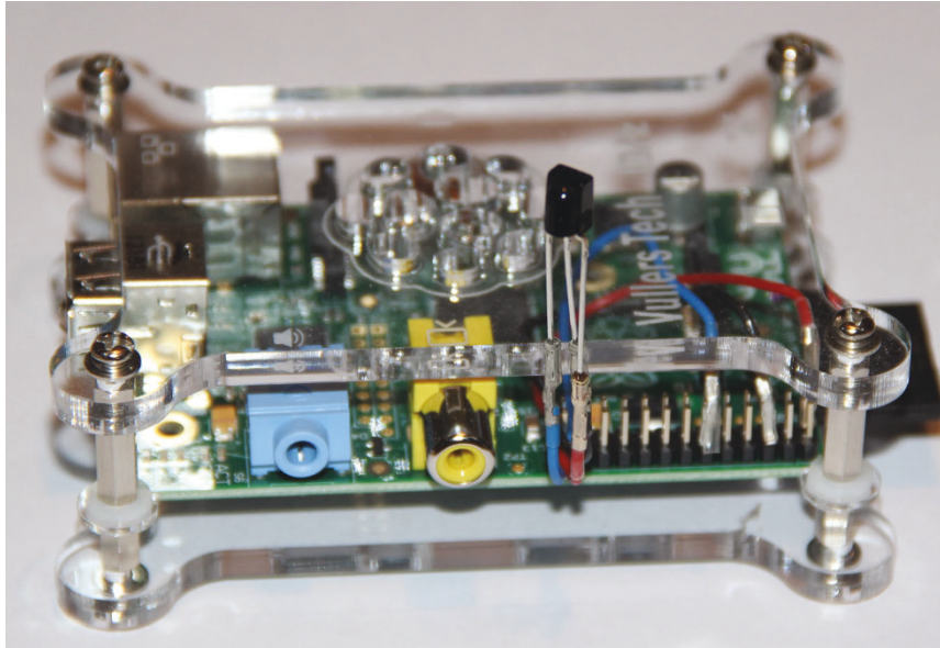
Abbildung 5.7: Die fertige lirc -Verkabelung an einem alten Raspberry Pi. Die Verkabelung für einen neuen Raspberry Pi sieht genau so aus, wenn Sie die GPIO-Pins von rechts aus zählen.
