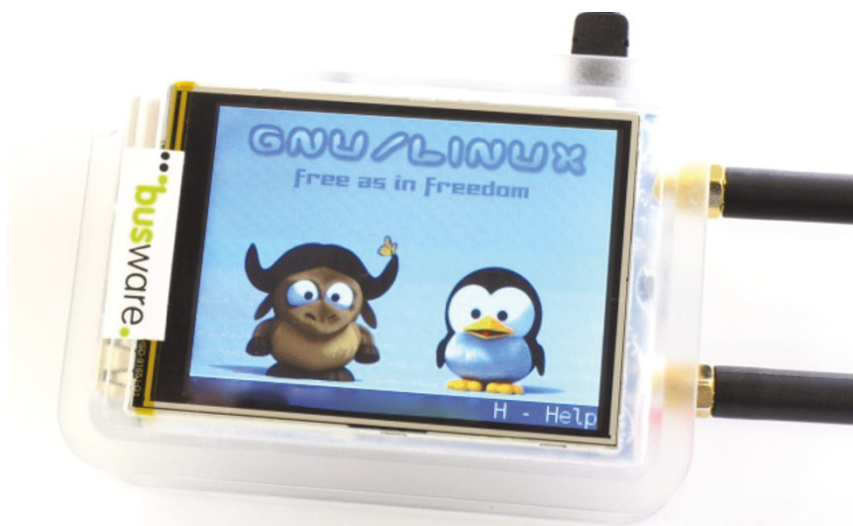
Abbildung 9.1: Busware macht's möglich: Raspberry Pi mit Display, 868 MHz Transceiver, RTC ( Real Time Clock ) und IR-Diode (Quelle: Busware).
