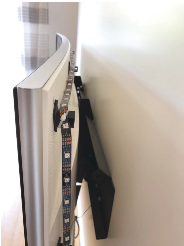
Abbildung 7.7: Der LED-Streifen kann mit Hilfe von Klebehaken und Kabelbindern hinter dem Fernseher befestigt werden. Für einen 55 Zoll-Fernseher werden ca. 16 Klebehaken benötigt. Die LEDs strahlen auch seitlich. Kleben Sie den Streifen direkt auf den Fernseher, müssen Sie evtl. die Ecken schneiden und neu löten. Das Ambilight macht selbst bei curved-Fernsehern eine gute Figur.
