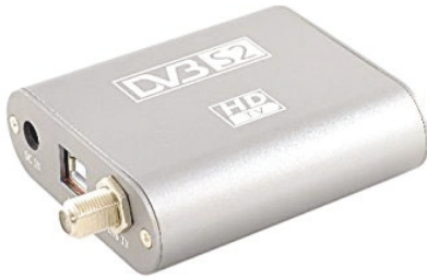
Abbildung 5.3: Die DVBSky S960 V2-Box benötigt eine Firmware-Datei (Quelle: amazon.de).
