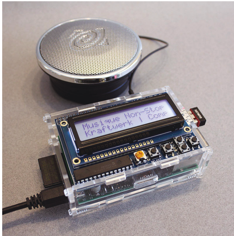
Abbildung 12.6: Adafruit bietet alle Teile an, die zum Bau eines WLAN-Radios erforderlich sind. Dazu gehören u. a. ein Display und diverse Taster (Quelle: Adafruit).
