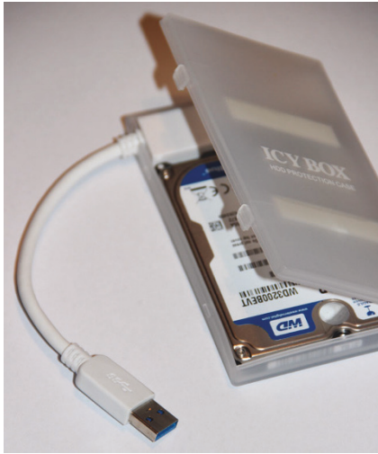
Abbildung 5.11: Eine per USB eingebaute 2,5 Zoll-Festplatte erweitert den Speicherplatz des Raspberry Pi. Aber Vorsicht: Für die externe Festplatte kann eine externe Spannungsversorgung erforderlich sein.
