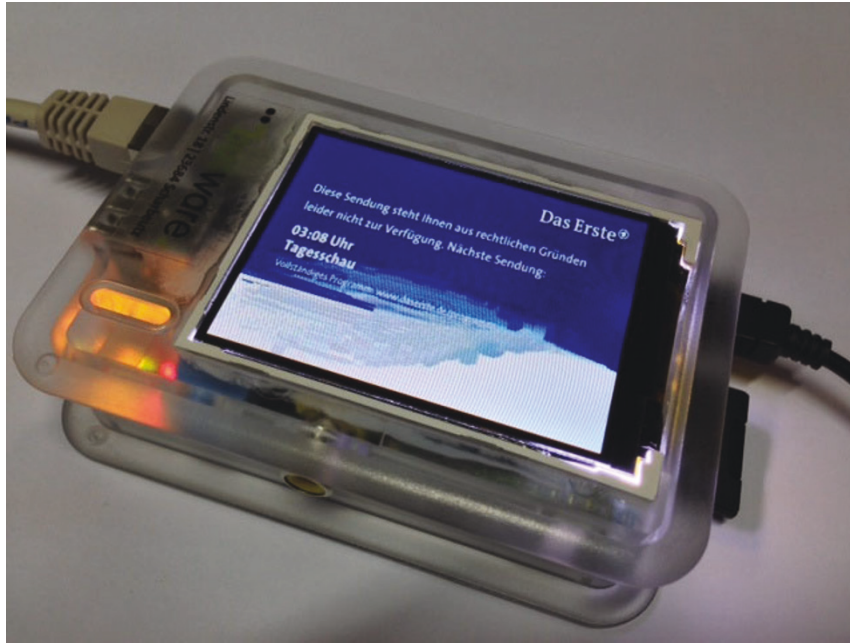
Abbildung 9.12: Mit fbcp wird das Fernsehprogramm des VDR im LCD angezeigt (Quelle: Busware).
