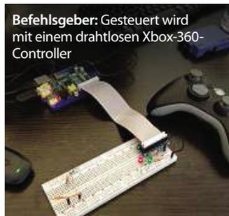
**Befehlsgeber:** Gesteuert wird mit einem drahtlosen Xbox-360-Controller
