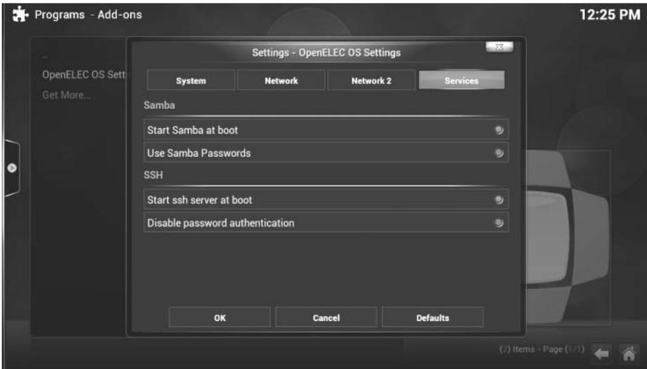
**Bild 7.1:** Das Aktivieren des SSH-Servers kann grundsätzlich auch via XBMC erfolgen. Bei der Inbetriebnahme von XBMC ist jedoch schon vorher der SSH-Zugriff notwendig. Alle Änderungen in diesem Add-on werden erst nach einem Neustart übernommen.
