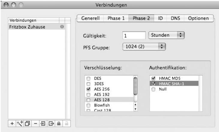
**Bild 8.13:** Wenige Klicks: Für die *Phase 2* wählen Sie das *AES 256*-Verschlüsselungsverfahren sowie *SHA-1* für die Authentifikation aus.
