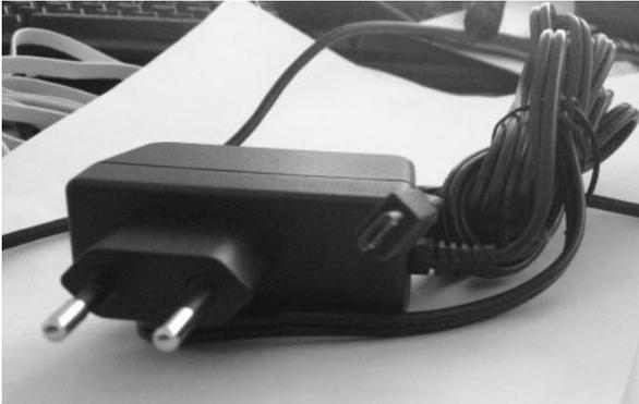
**Bild 2.4:** Um die 5 Euro werden für ein leistungsfähiges Netzteil für den Raspberry Pi fällig. Wegen des Micro-USB-Anschlusses und des geringen Stromverbrauchs eignen sich vor allem Netzteile aus dem Handyzubehörmarkt.
