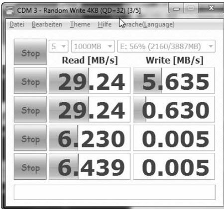
**Bild 4.4:** Wer ist der Schnellste? Um die tatsächliche Geschwindigkeit des Flashspeichers herauszufinden, nutzen Sie das kleine Benchmark-Programm.
