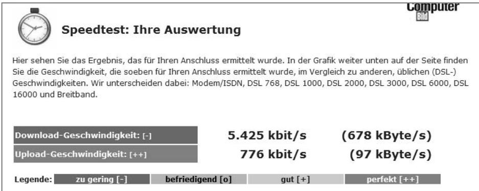
**Bild 8.108:** Zu gering: Für einen 16.000er-Anschluss ist das Testergebnis ernüchternd. Hier sorgt eventuell ein Anruf bei der Provider-Hotline für Abhilfe.
