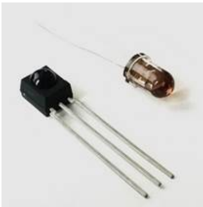
Abbildung 3-7: IR-Sender und Empfänger-Diode
