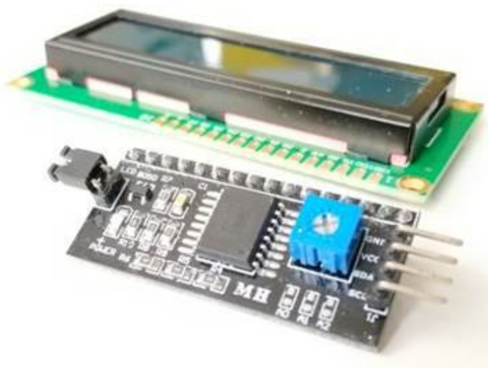
Abbildung 3-4: LCD Anzeige mit I2C-Interface
