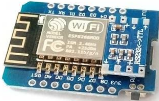
Abbildung 4-15: D1 Mini ESP8266 und aufgelegtes MAX3232-Breakout (Suchbild)
