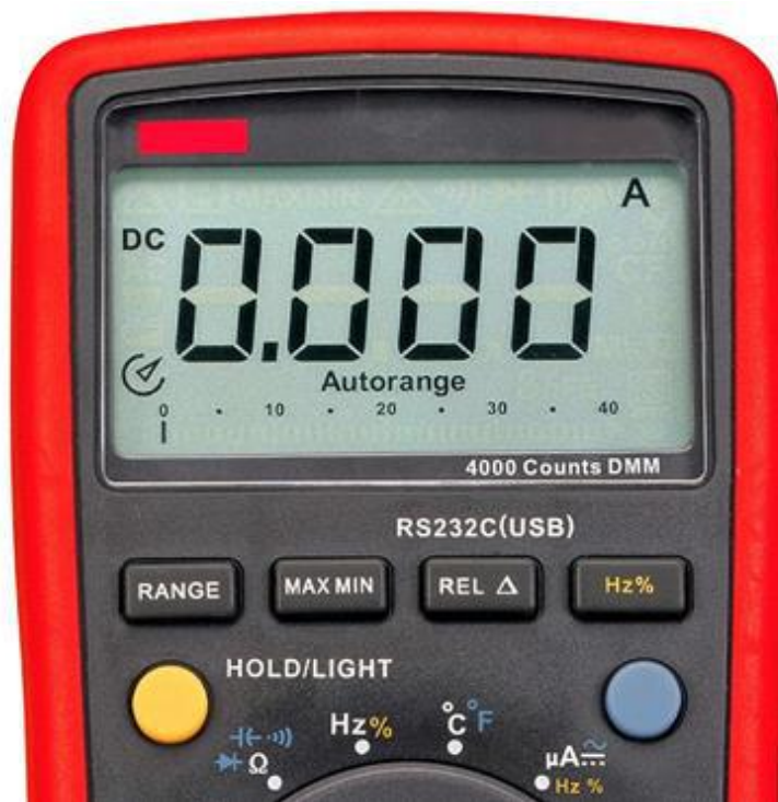
Abbildung 4-16: Multimeter mit PC-Schnittstelle (RS232/USB)
