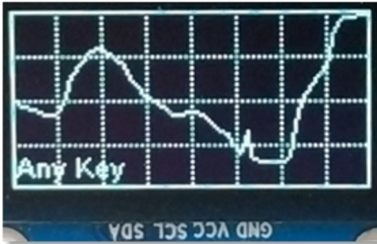
Abbildung 3-3: OLED-Grafik mit LDR- und Taster-Abfrage
