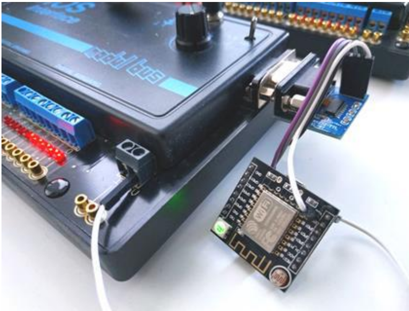
Abbildung 4-58: RS232-Sios-Interface mit echtem Analogausgang und ESP-Server-Entwurf
