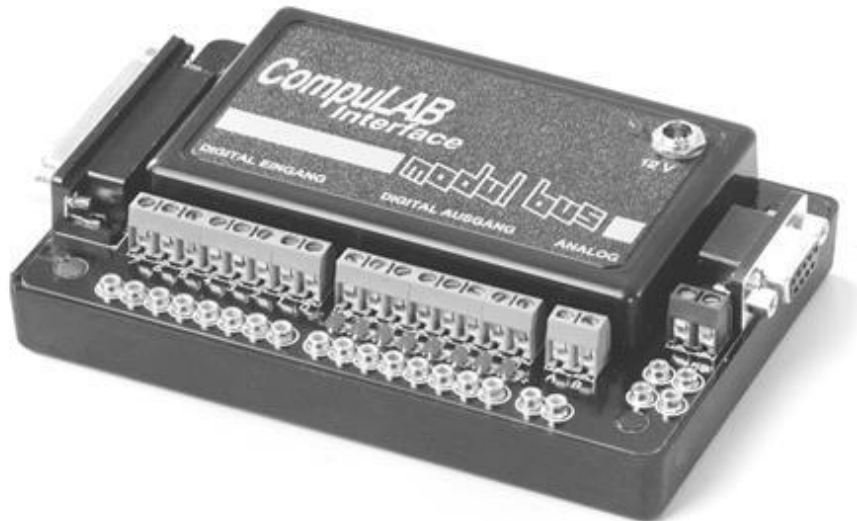
Abbildung 4-9: Altes RS232-Interface mit Sub-D9-Buchse (female) an der Seite
