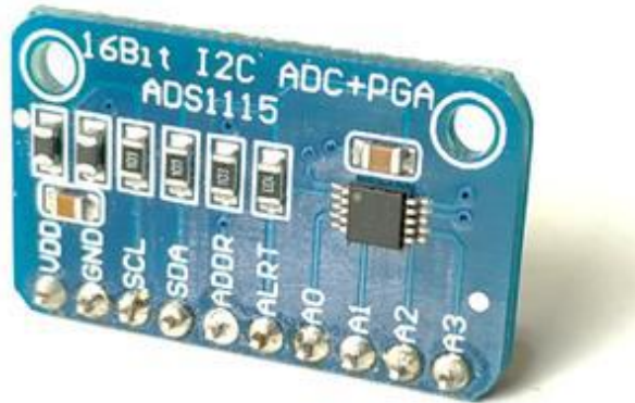
Abbildung 4-22: 4x Analog-Eingang mit 16 Bit und Verstärker: ADS1115
