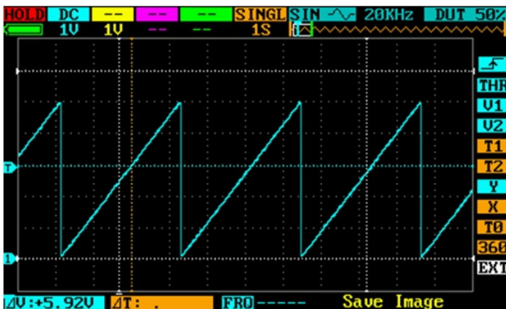
Abbildung 4-44: Sägezahn aus dem MPC4725
