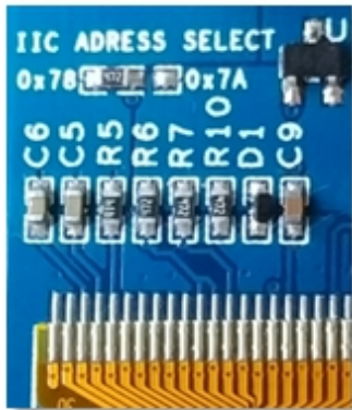
Abbildung 3-11: Veränderbare Adressen eines OLED-Displays
