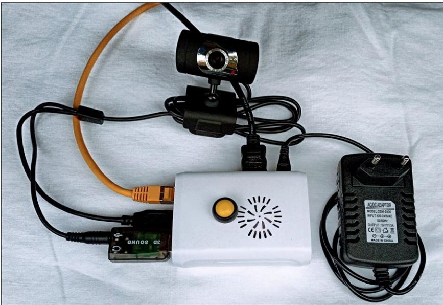
**1** Die Hardware – hier mit einer älteren Webcam und gesonderter USB-Soundkarte.
