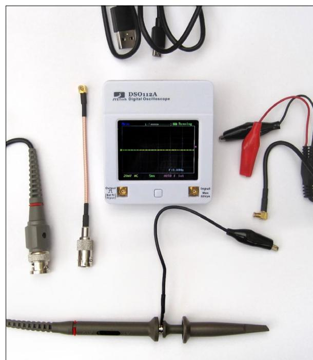
**2** Das DSO112A kommt in einem Set mit Kabeln zum Anschluss von verschiedenen Komponenten sowie einem Akku.
