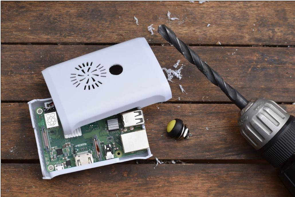
**2** Den Taster montieren Sie mittig auf der Gehäuseoberseite.
