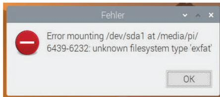
**Abb. 4.46** Fehler beim Einhängen eines Datenträgers
