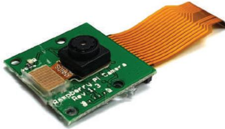
**Abb. 2.18** Raspberry Pi Kamera, Revision 1.3 mit Flachbandkabel
