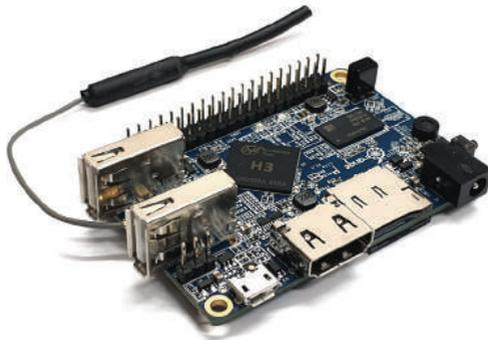
**Abb. 2.19** Orange Pi Lite Version 1.1 mit W-Lan Antenne
