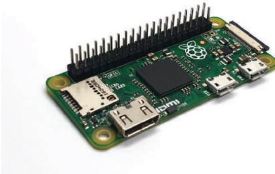
**Abb. 13.2** Raspberry Pi Zero mit 40-Pin Header
