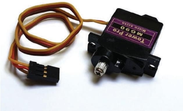
**Abb. 9.8** Modellbau-Servomotor
