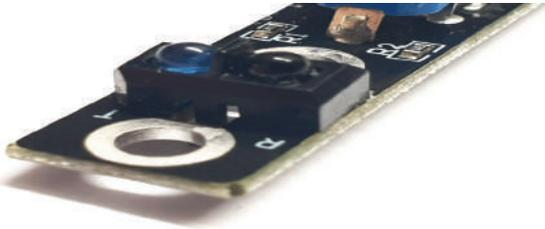
**Abb. 14.6** Infrarotdiode und Empfänger auf dem Sensormodul
