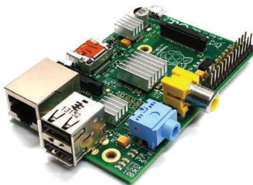
**Abb. 2.2** Raspberry Pi 1 Modell B mit Aluminiumkühlkörpern<sup>5</sup>
