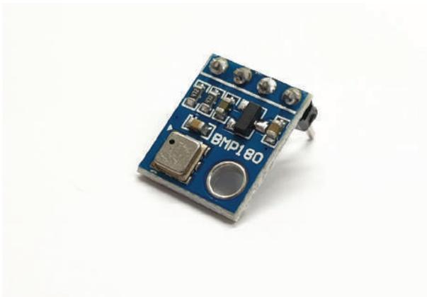
**Abb. 19.1** BMP180 Modul mit kombiniertem Luftdruck- und Temperatursensor
