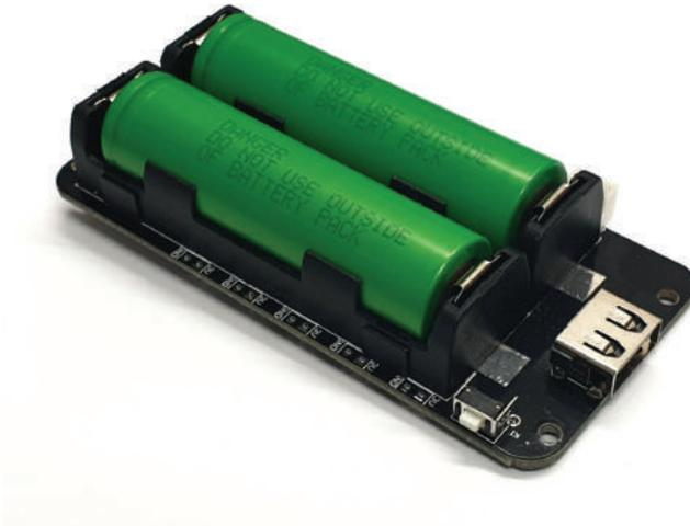
**Abb. 14.4** Akkumodul mit zwei 18650 Lithium Akkus
