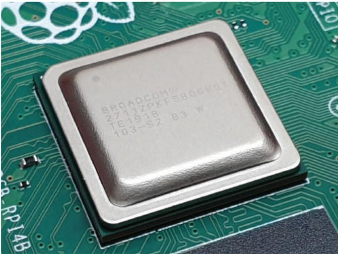
**Abb. 2.1** Das SoC Paket auf einem Raspberry Pi 4 B
