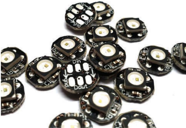
**Abb. 7.2** RGB LED Module mit eingebautem Vorwiderstand und IC zur Ansteuerung
