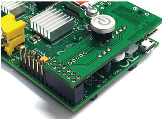
**Abb. 6.36** Remote Pi HAT auf einem Raspberry Pi 1 Modell B
