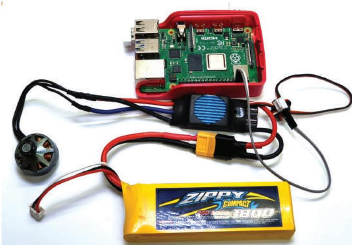
**Abb. 9.4** Anschluss eines bürstenlosen Motors mit ESC an den Raspberry Pi
