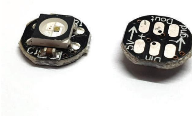
**Abb. 20.2** Die verwendeten WS2812B RGB-LEDs. Gut zu erkennen sind die einzelnen Anschlüsse mit Beschriftung.
