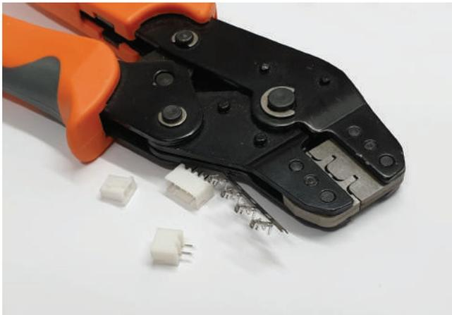
**Abb. 17.5** Crimpzange für JST Stecker und Buchsen
