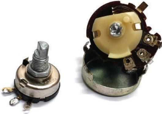
**Abb. 6.9** Verschiedene Drehwiderstände. Rechts ist auch der Schleifkontakt zu sehen.
