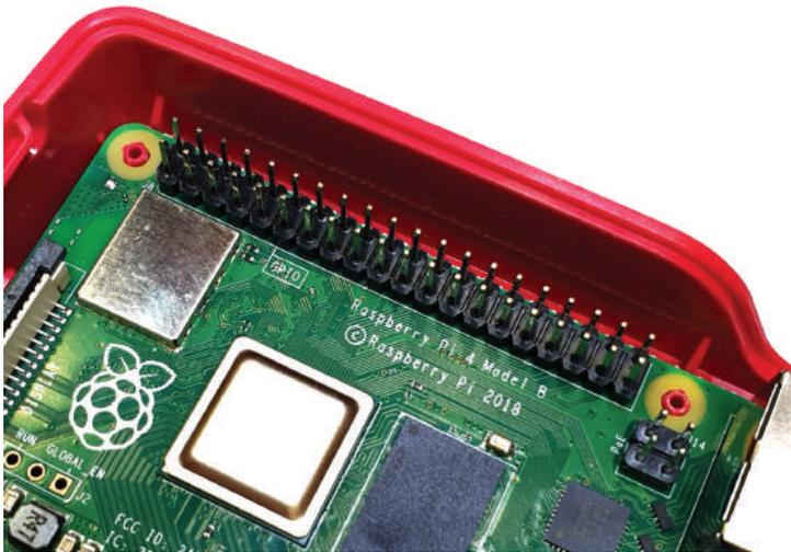
**Abb. 6.30** GPIO Pin-Leiste am Raspberry Pi 4 Modell B
