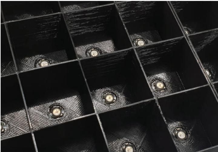
**Abb. 20.3** 3D-gedruckter Kunststoffeinsatz zur optischen Trennung der Pixel
