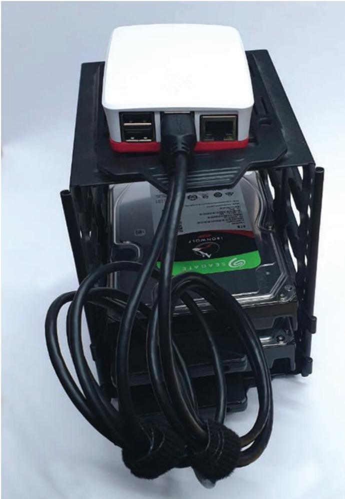
**Abb. 11.8** Unser Raspberry Pi Netzwerkspeicher. Eingebaut in einen Festplattenkäfig.
