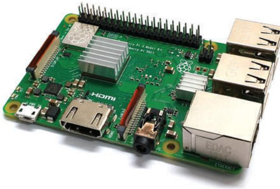
**Abb. 2.11** Raspberry Pi 3 Modell B+ mit Aluminiumkühlkörpern
