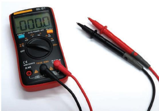
**Abb. 6.4** Ein digitales Multimeter mit zwei Messleitungen
