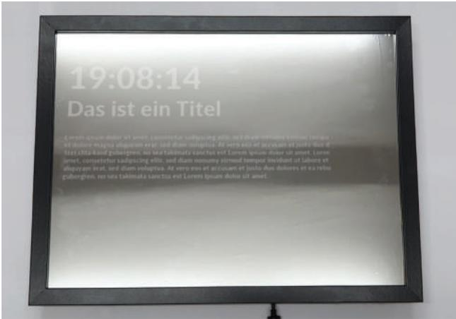
**Abb. 15.2** Der Smart-Mirror mit einer Dummy-Ausgabe eines Newsbeitrags
