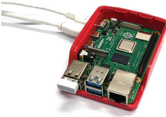
**Abb. 3.2** Raspberry Pi4 B im offenen Gehäuse mit angeschlossenem Netzteil, HDMI Kabel und kabellosem USB-Tastatur- und Mausempfänger
