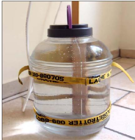
Spannriemen statt Klebeband: Die Stativstange lässt sich auch durch Riemen mit Schnellverschluss festzurren, und das Stativ bleibt damit leicht zerlegbar und transportabel.
