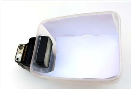
Selbst gebaute Lightsphere: Ein verschließbarer Essensbehälter aus weißem Kunststoff dient hier als großzügiger, aufsteckbarer Lichtdiffusor für einen starken, indirekten Blitz.
