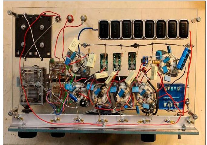
Verdrahtung: Auf der Unterseite ist die Verdrahtung frei schwebend ausgeführt und stützt sich an den Röhrensockeln und einigen zusätzlichen Lötösen ab.
