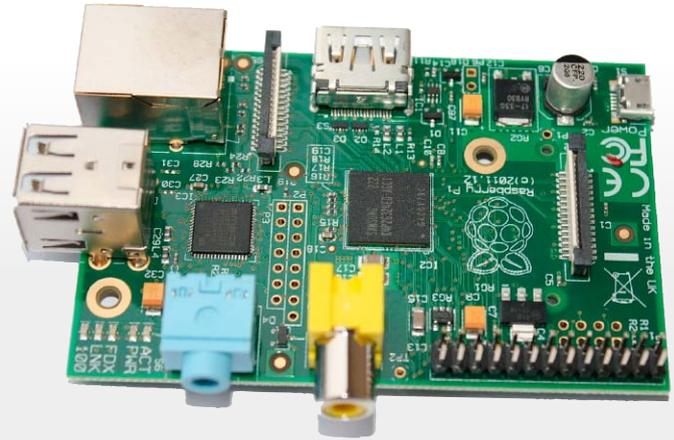
Raspberry Pi Modell B: Das ältere Modell B ist nur mit zwei USB-Schnittstellen ausgestattet und überträgt das Bild über HDMI oder den Composite-Ausgang.
