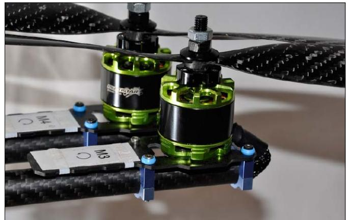
Motorträger-Mitnehmer: Die Befestigungsgewinde der Motoren passen perfekt zu den mitgelieferten Motorträgern von Tarot-rc.
