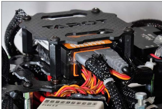
Naza-Empfänger: Die Steuerelektronik Naza M V2 wird etwas erhöht auf einer Karbonplatte verbaut, die mit Aluabstandshaltern auf der Centerplate verschraubt ist.
