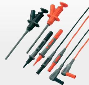
Ein zusätzliches Set an Messkabeln mit austauschbaren Prüfspitzen: Klemmen und Grabber halten eine Hand zur Bedienung des Multimeters frei, etwa zum Speichern von Messwerten.
