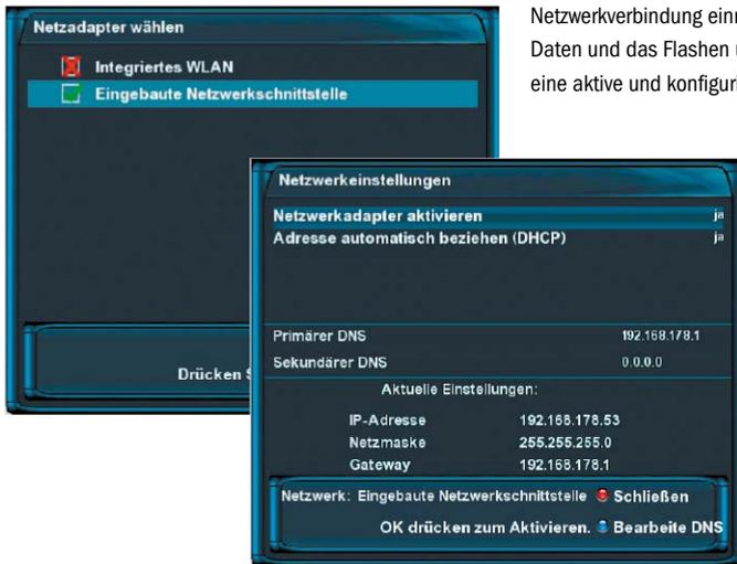
Netzwerkverbindung einrichten: Für die Sicherung der Daten und das Flashen übers Netzwerk benötigen Sie eine aktive und konfigurierte LAN-Schnittstelle.
