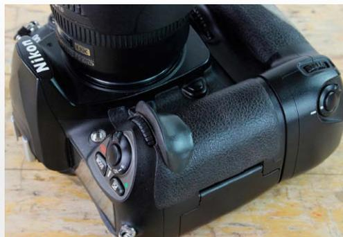
Abgewetzten Griff ersetzen: Mit der härtenden, elastischen Silikonmasse Sugru erledigen Sie kleinere Reparaturen an Kamera- und Objektivgehäusen im Notfall und auf Reisen selbst.
