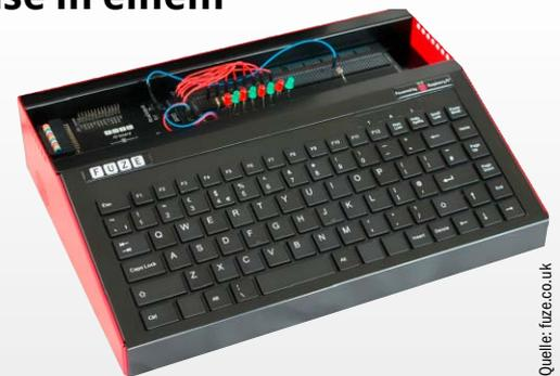
Eine Hommage an die 80er-Jahre: Das Gehäuse des Fuze erinnert mit seiner Tastatur an den ZX Spectrum und kommt Bastlern mit einer offen gelegten Steckplatine und einem abgesicherten I/O-Board entgegen.
