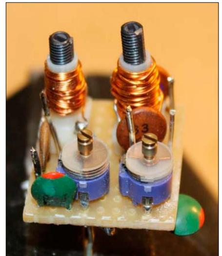
Die KW-Spulen: Für diese Spulen kommt Kupferlackdraht zum Einsatz. Die Drahtstärke ist unkritisch.
