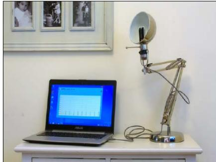
Umbau einer Schreibtischlampe: Neben dem Gelenkfuß ist ein USB-Kabel (Mitte), ein Reflektor und ein WLAN-Adapter statt Lampenfassung nötig.
