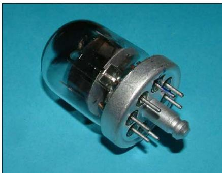
Die verwendeten Röhren 2SH27L: Ohne Abschirmbecher (wie im Bild) sind die Röhren ästhetisch ansprechender als im Metallkäfig.
