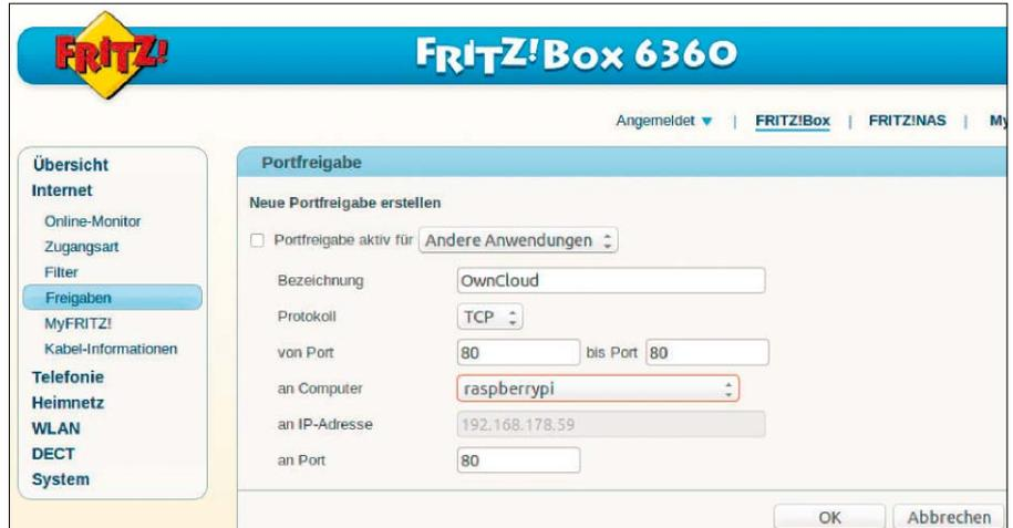
Erreichbarkeit aus dem Internet: Soll die Owncloud von außen erreichbar sein, müssen in der Konfiguration des DSL-Routers die Ports 80 und 443 an den Cloud-Server weitergeleitet werden.
