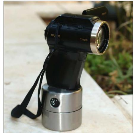
Einmal im Kreis: Diese Eieruhr von Ikea dreht sich in 60 Minuten um 360 Grad und dient hier als rotierendes Panoramastativ für Zeitrafferaufnahmen. Die leichte Kamera ist mit doppelseitigem Klebeband angebracht.
