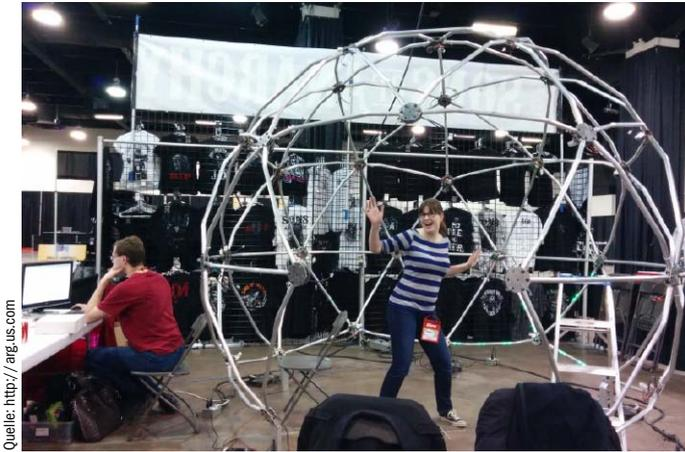
Geodätische Kuppel: Der 3D-Scanner Argus nimmt Objekte oder Personen mittels 35 Raspberry-Pi-Platinen mit Kamera-Boards aus verschiedenen Perspektiven auf, um aus den Aufnahmen ein 3D-Modell zu berechnen.
