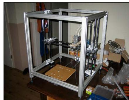
In der Bauphase: Der Grundrahmen aus Aluminium sowie die Führungen aus Stahl sind fertiggestellt. Noch ist das Monster ist ein „Silver Monster“ ohne Motoren.
