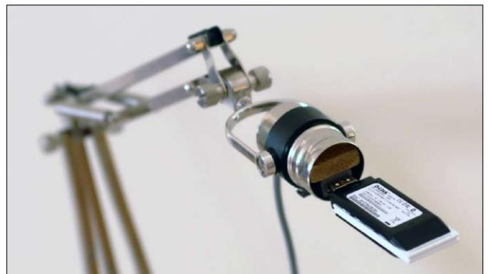
te genug, und für stabile Verbindungen sorgen wieder Kabelbinder. Die Abbildung unseres WLAN-Reflektor-Siebs gibt weitere Anregungen zum Aufbau aus verfügbaren Teilen.
