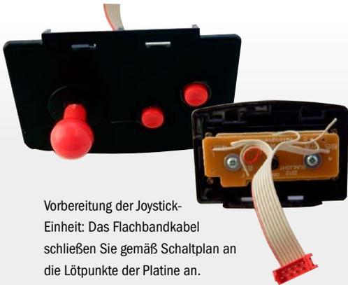
Vorbereitung der Joystick-Einheit: Das Flachbandkabel schließen Sie gemäß Schaltplan an die Lötunkte der Platine an.
