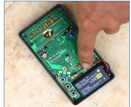
Feinsicherung eines digitalen Multimeters nach CAT II: Flinke Sicherungen schützen das Multimeter vor einer versehentlichen Zerstörung, wenn der Strommessbereich zum Messen von Ampere falsch gewählt wurde.
