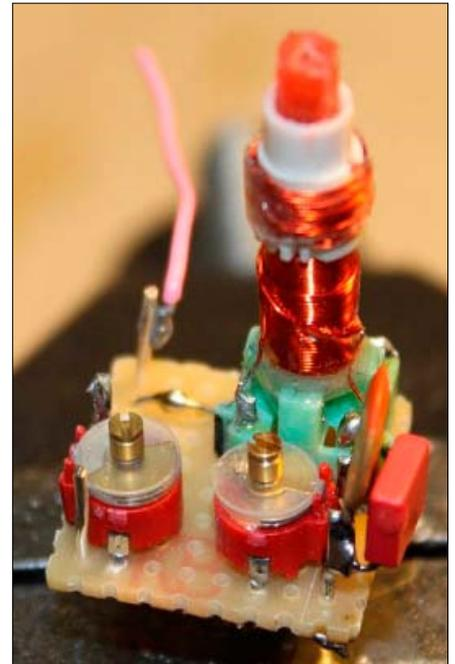
Die MW-Spule: Die MW-Eingangsspule wird mit HF-Litze auf den Ferritstab gewickelt.
