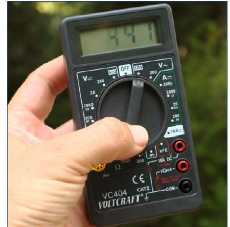
Kleines Multimeter der Kategorie 2 (CAT II): Dieses digitale Multimeter genügt für Haushaltsgeräte, die mit dem Niederspannungsnetz (230 V AC) verbunden sind, jedoch nicht für Messungen an der Gebäudeinstallation.
