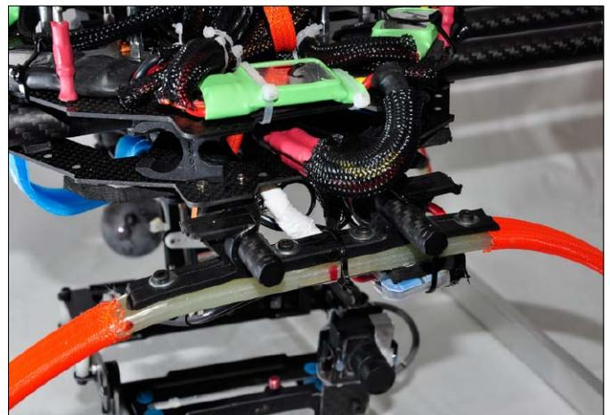
Landegestell-Clips: Diesen glasfaserverstärkten Bügel haben wir zweigeteilt und an den Nutzlaststangen befestigt. Als Kufen dient ein Aluvierkant aus der Restekiste.
