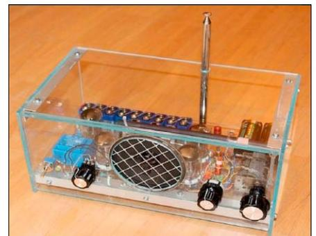
Der fertige AM-Röhren-Super: Mit dem vollständigen Plexiglasgehäuse macht er sich gleichermaßen gut als Blick- wie als Wellenfänger.
