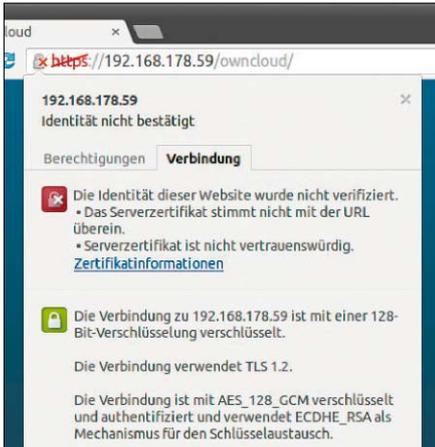
Zertifikate im Einsatz: Der Chrome-Browser erkennt das mit Open SSL erzeugte Zertifikat nicht an und lässt keine sichere Verbindung zu.
