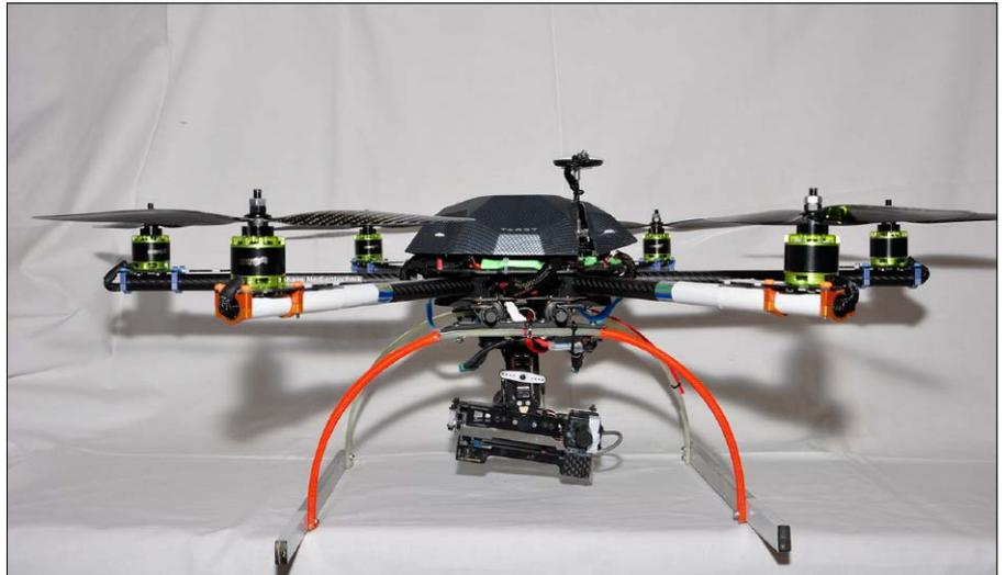
Kein Leichtgewicht: Alles zusammen bringt der Multicopter 3360 Gramm auf die Waage. Die steife Rahmenkonstruktion sorgt jedoch für eine stabile Fluglage.
