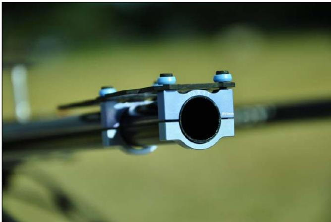
Motorträgerhalterung: Hochwertige M3-Schrauben dienen der Befestigung auf den CFK-Motorträgern, die Bohrungen passen ohne zusätzliche Nacharbeit.
