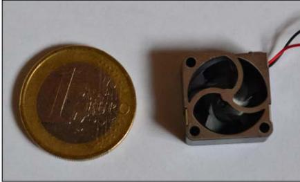
Lüfterwinzling und Stromversorgung: Dieser Kühler ist zwar nicht speziell für den Raspberry Pi konzipiert, passt aber optimal auf dessen CPU.
